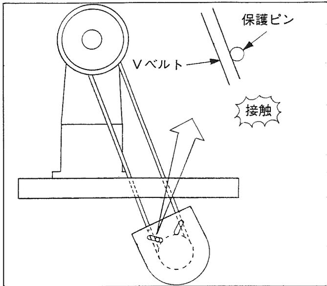
本マシンでは、モータープリーカバーの保護ピンを使用すると、Vベルトが保護ピンに接触してしまいます。この状態を回避するため、モータープリーカバー取付前に必ず以下の作業を行ってください。
