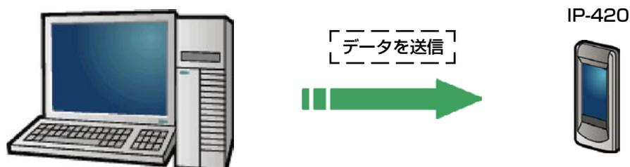
パソコンとIP-420を接続し、PM-1でデータ作成後ミシンへデータを送信してください。IP-420が、データ入力画面になると自動的に試縫い画面が表示されます。PM-1の操作方法については、PM-1のヘルプ等をご覧ください。
