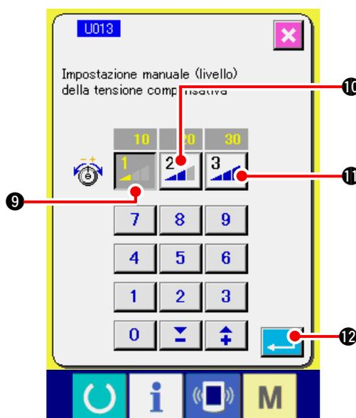
**6) Impostare il valore di livello della tensione del filo compensativa manuale (livello).**
