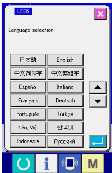
A la première mise sous tension, l'écran de sélection de langue s'affiche. Sélectionner la langue désirée. (La modification s'effectue avec le paramètre **U026** de l'interrupteur logiciel.)
