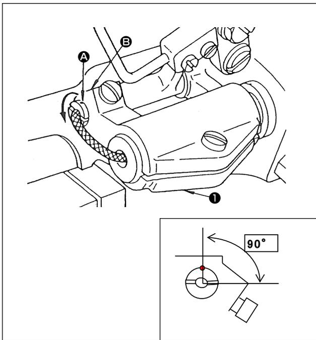
標準の傾きは、送り台軸の刻点 **A** が送り台腕 **①** の **B** に対して  $90^\circ$  上向きです。
