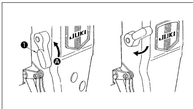
押えを上げた位置で停止させるには、押え上げレバー **1** を **A** の方向に回します。
