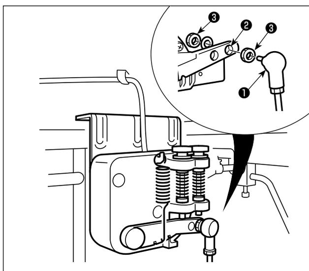
連結棒①は、ペダルレバーの取付穴②にナット③で止めます。
