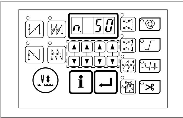
ペダルセンサーを変更した場合は、変更したペダル仕様に合わせて機能設定 No.50 の設定値を変更してください。
