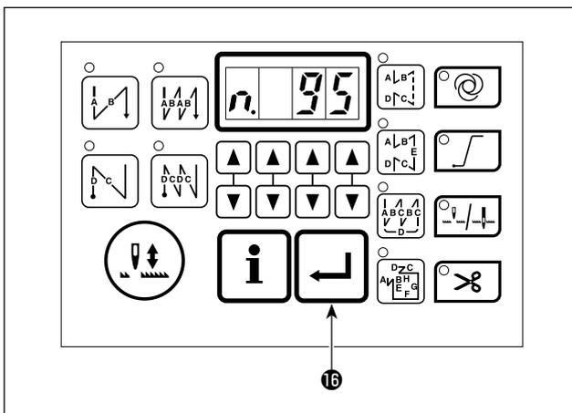
4) 頭部タイプを選択後、
