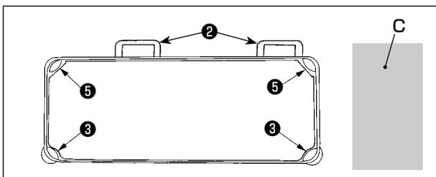
3) テーブル溝の四隅でオイルパンを支えるようにしてください。ゴムヒンジ座②をテーブルに取り付け、釘でテーブルに固定します。
