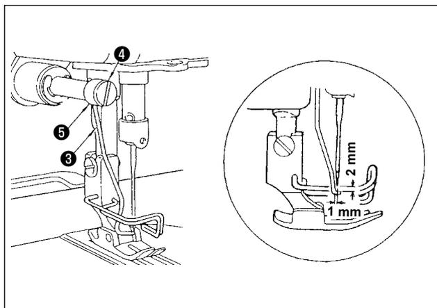
2) ワイパーカラー⑤で、ワイパー③を押すようにワイパー調節ねじ④を締めて、固定します。ワイパー③の平部と針心までの距離が 1 mm になるようにします。
