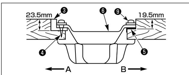
4) 手前側 A の 2 つは頭部支えゴム座③を釘④でテーブルの張り出した部分に打ちつけ、ヒンジ側 B の 2 つは頭部クッション座⑤を釘で打ち付けて固定し、オイルパン⑥をのせてください。
