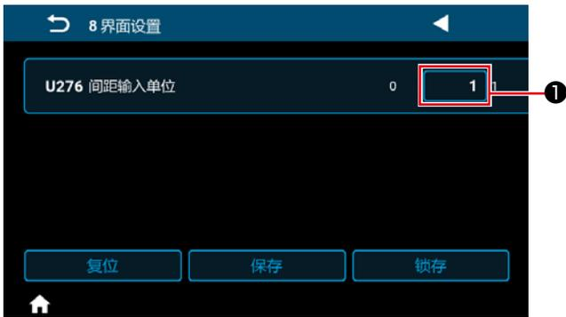
如果将 U276 间距输入单位①设定为 1，就可以用每 1 英寸的针数设定缝制接缝长度。
