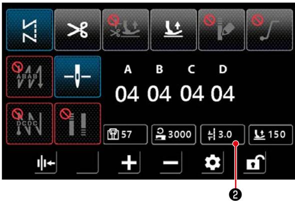
1) 当每 1 英寸的针数设定功能有效时，只要按下缝制接缝长度按钮 **3.0** ②，就会显示每 1 英寸的针数设定画面。
