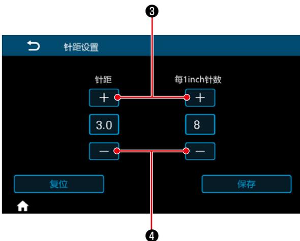
2) 只要用+-按钮输入每 1 英寸的针数，就会变为应对的缝制接缝长度。
