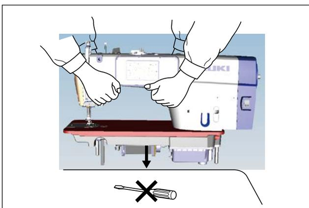
2) 设置缝纫机时，请注意一定要水平地放置到平坦的地方，同时不要放置螺丝刀等凸起物品。
