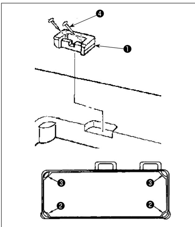
3) 在机台槽的四个角上放置防振动橡胶**2****3**，请用针**4**（1根）固定。（防振动橡胶是2种）
