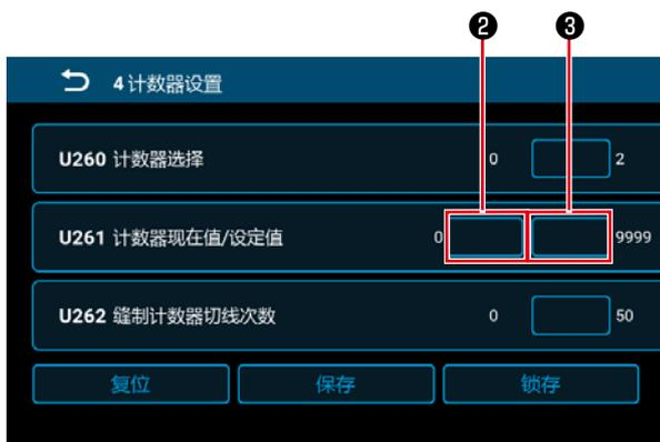
2) 在计数器设定画面上设定 U261 的计数器设定值**③**。在缝制画面上进行缝制，只要计数器当前数值**②**到达设定值，就会显示计数器设定画面。在 U260、U262 上设定计数方法（请通过设定一览参考内容）。
