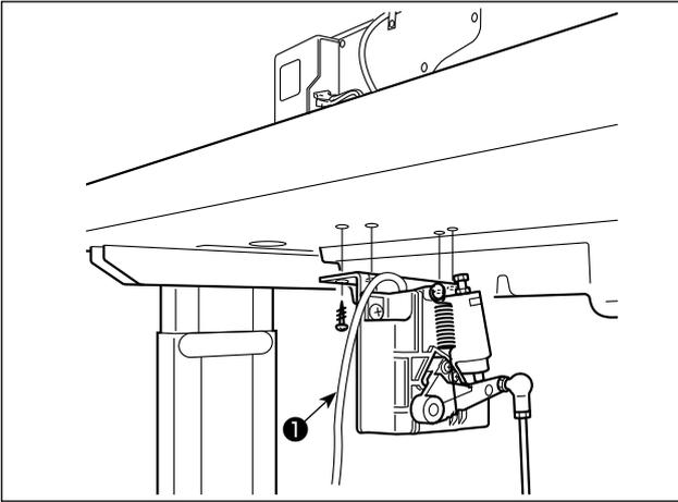
1) 请使用 4 根附属的安装螺丝①，在机台里侧安装踏板感应器。
