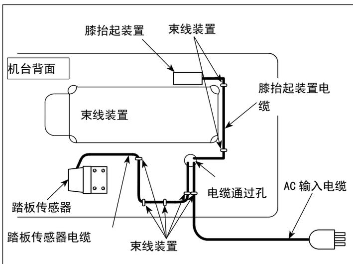
2) 将踏板电缆、AC 输入电缆、膝抬起装置电缆固定于束线装置。
