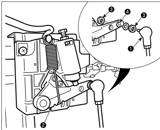
连结杆①用螺母③固定到踏板拨杆②的安装孔④。
