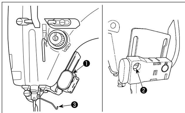
A altura do interruptor de alimentação reversa 1 é ajustável.
