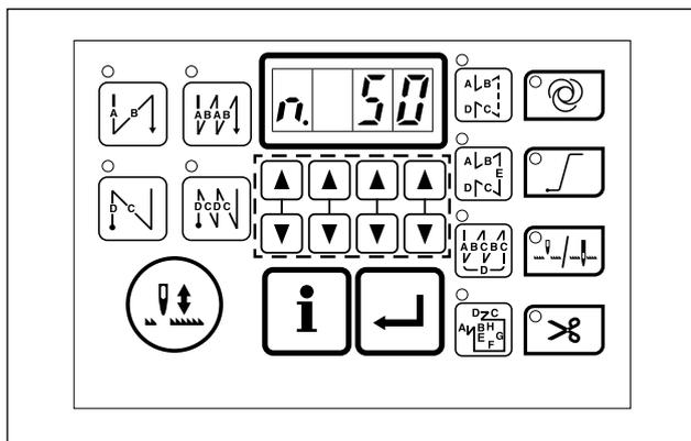
Quando substituir o sensor do pedal, altere o valor de definição da função Nº 50 de acordo com as especificações do novo pedal conectado.
