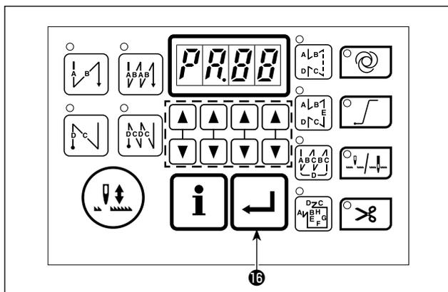
a) Verifique o dígito intermitente para determinar a direção de deslocamento do pedal.
