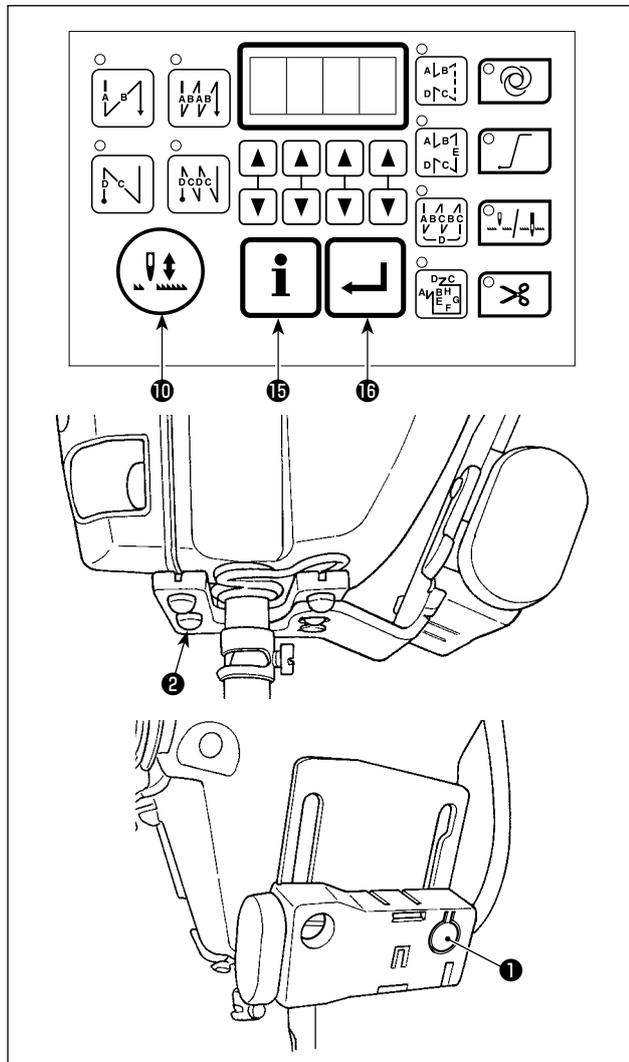
A máquina de costura vem equipada com uma luz LED que ilumina a área de entrada da agulha.
