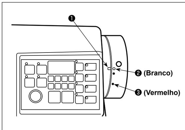
A posição de parada superior da barra da agulha é alcançada quando o ponto de marcação ① na tampa se alinha com o ponto de marcação branco ② no volante.
