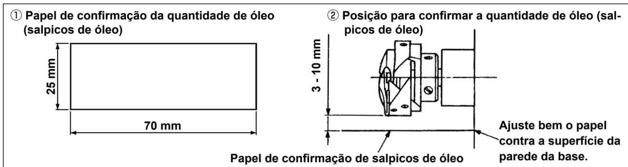
\* Quando realizar o procedimento descrito em 2) abaixo, retire a chapa deslizante e preste muita atenção para não permitir que seus dedos entrem em contato com a lançadeira.
