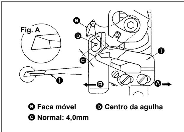
Se a faca não cortar a linha bem, afie de novo a contra-faca ❶ imediatamente como mostrado na Fig. A e instale-a de novo adequadamente.
