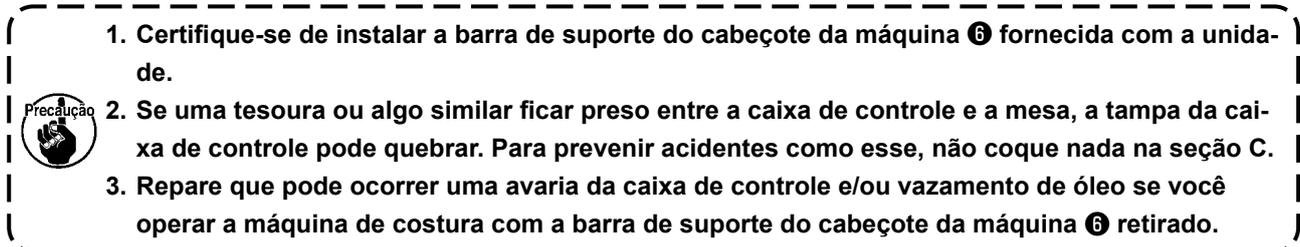
1. Certifique-se de instalar a barra de suporte do cabeçote da máquina 6 fornecida com a unidade.
