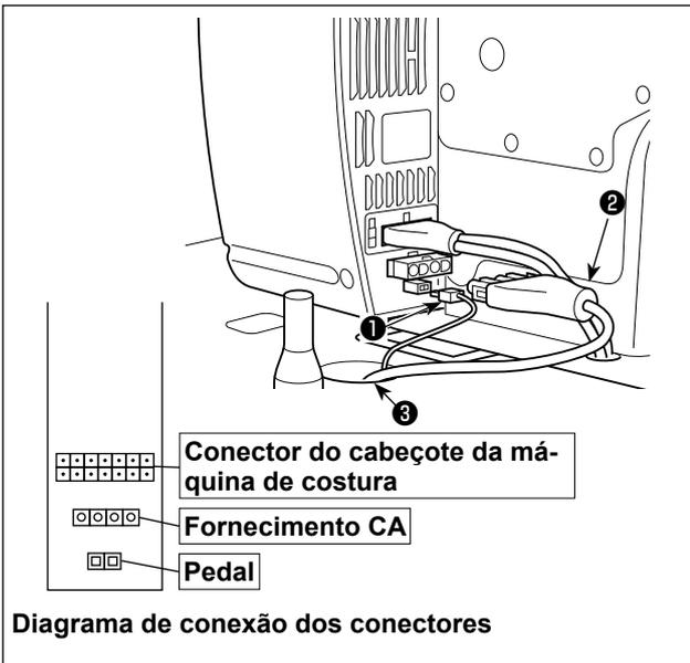
Diagrama de conexão dos conectores
