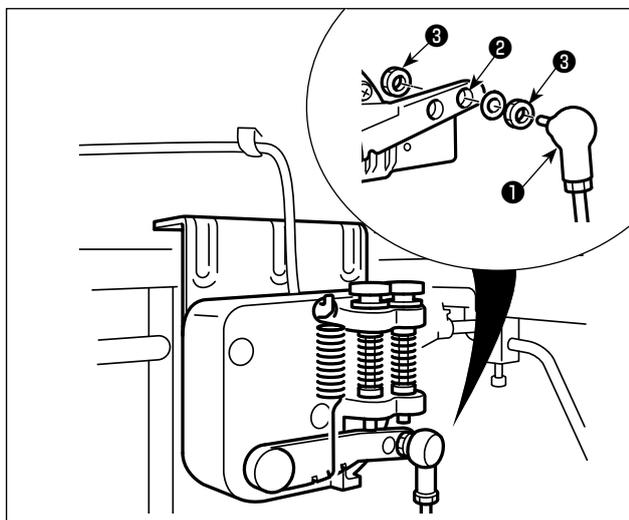
Fixe a haste de conexão ❶ no orifício ❷ de instalação da alavanca do pedal com a porca ❸.
