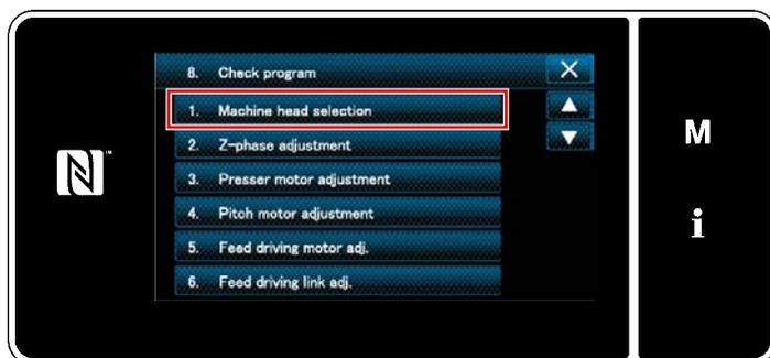
2) Sélectionner "1. Machine head selection (Sélection de la tête de la machine)" pour vérifier la tête de machine sélectionnée.
