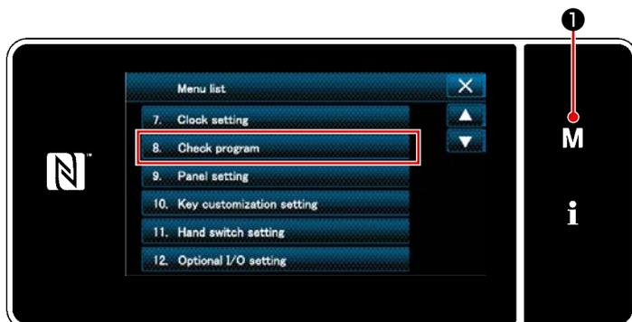
1) Mettre la machine sous tension tout en maintenant enfoncé **M** ①.
