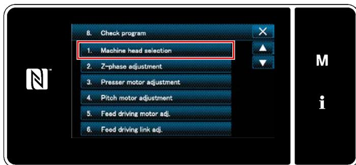
2) Wählen Sie "1. Machine head selection (Maschinenkopf-Auswahl)", um den ausgewählten Maschinenkopf zu überprüfen.
