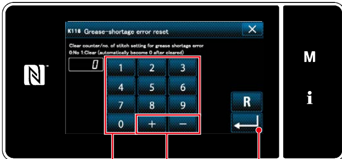
<Gres bitti hatası sıfırlama ekranı>
