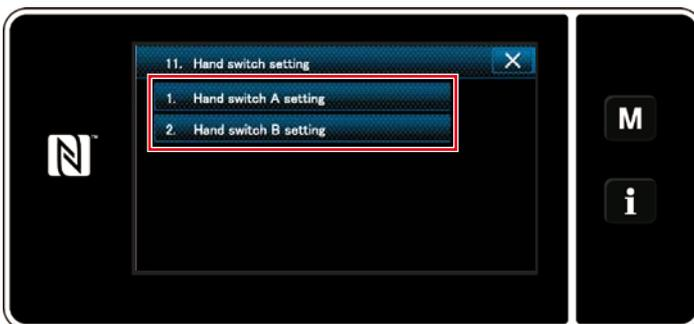
3) Sélectionner l'interrupteur à régler.
