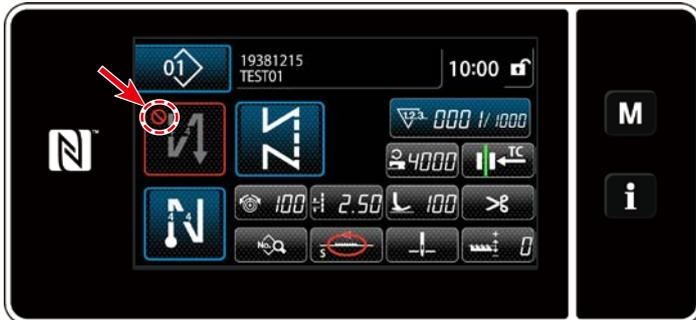
Das Rückwärtsnähtmuster am Nahtanfang kann verwendet werden, wenn die Funktion für Rückwärtsnähen am Nahtanfang in den EIN-Zustand versetzt wird (das Zeichen
