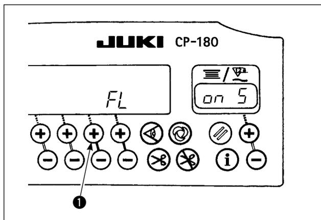
Когда автоматическое подъемное устройство (АК) подсоединено, эта функция приводит в действие автоматическое подъемное устройство.
