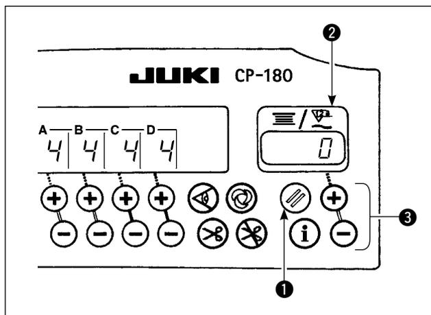
Индикация счетчика количества нитки на катушке может быть заменена на индикацию счетчика обрезки ниток (упрощенный швейный счетчик) как показано ниже.
