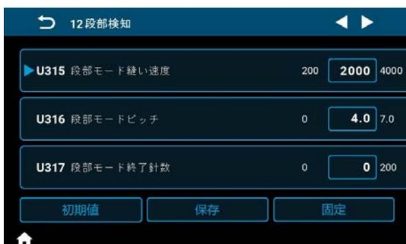
1) 段部検知機能が設定されているときに段部を検出すると縫い速度と縫い目長さが段部モードの設定値に切り替わります。
