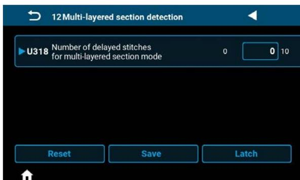
Quando ci si avvicina a una sezione multistrato, a seconda delle condizioni di cucitura, la modalità potrebbe commutarsi alla modalità di sezione multistrato prima di raggiungere la sezione multistrato.
