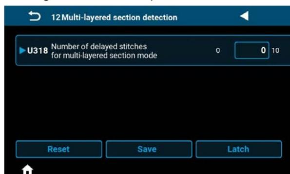
Lorsque vous vous approchez d'une section à plusieurs couches de tissu, en fonction des conditions de couture, la machine peut passer en mode Section à plusieurs couches de tissu avant que cette section soit atteinte. En définissant le nombre de points à coudre avant de passer au mode Section à plusieurs couches de tissu, vous pouvez retarder cette transition.
