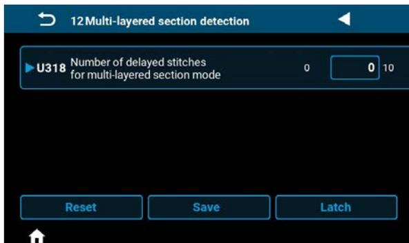
Al acercarse a una sección multicapa, dependiendo de las condiciones de cosido, puede que el modo cambie al modo de sección multicapa antes que se alcance la sección multicapa.
