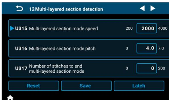
Aunque el modo de sección multicapa se finalice automáticamente cuando se supere el valor de umbral, también se puede finalizarlo ajustando el número de puntadas.
