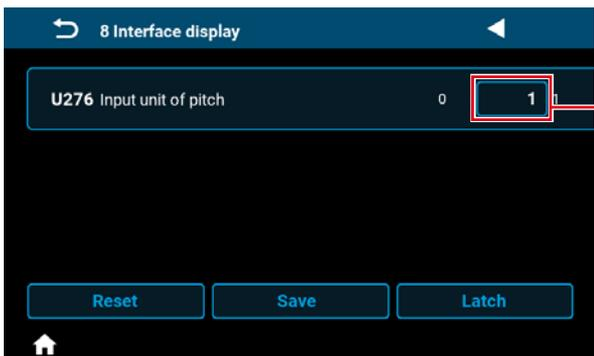
Se puede ajustar la longitud de la puntada utilizando el número de puntadas por pulgada mediante el ajuste de "U276 Unidad de entrada de paso" a ❶ .
