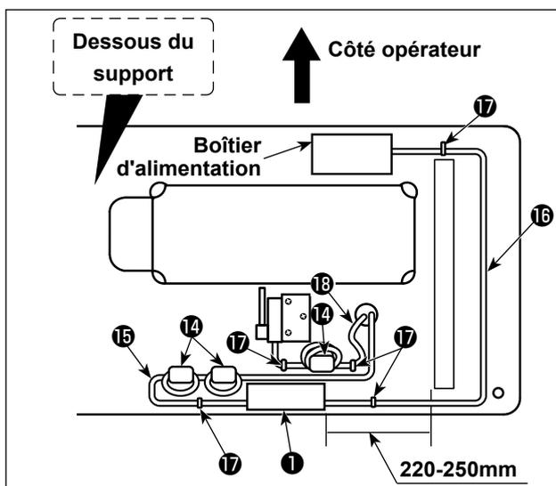
11) Pour deux noyaux toroïdaux ⑭ , serrez le cordon d'alimentation du coffret de branchement après avoir enroulé le câble autour du tore du noyau toroïdal deux fois.
