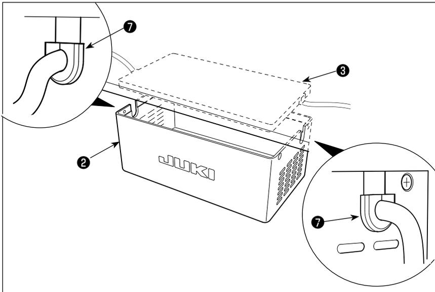
9) Monter le couvercle du réacteur ② sur l'ensemble de la base du réacteur ③ .
