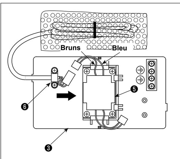
3) Faites glisser le réacteur ⑤ dans le sens de la flèche pour l'insérer dans l'ensemble de la base du réacteur ③ .
