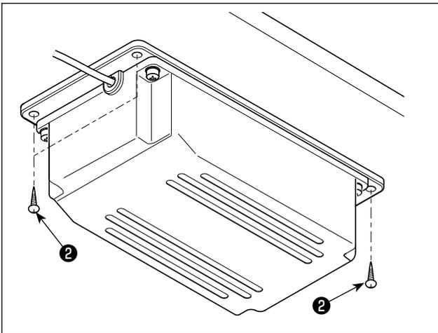
2) Retirez les vis à bois ❷ du sac des accessoires et installez la boîte du réacteur sous la table. (4 emplacements de serrage des vis)
