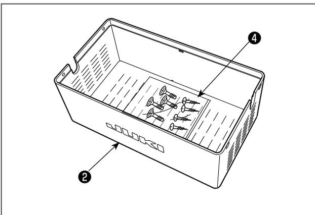
2) Retire la bolsa de tornillos ② de la cubierta ④ .
