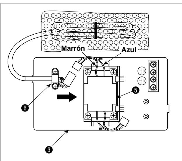
3) Deslice el reactor ⑤ en la dirección de la flecha para insertarlo en el conjunto de la base del reactor ③ .
