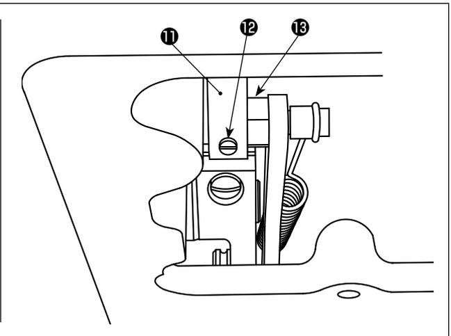
9) 请用手动方式向箭头方向旋转飞轮，并确认实际的缝纫接缝长度。依靠实际的缝纫接缝长度和输送旋钮**②**设定的刻度上如果存在偏差，请松开输送调节台**⑪**的固定螺丝**⑫**，用扳手对输送调节针**⑬**进行调节。
