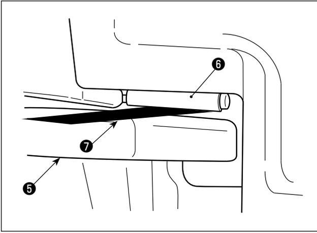
5) 请让输送调节旋钮**②**的刻度对准“7”，请在逆向输送杠杆**⑤**和逆向输送杠杆制动器**⑥**之间夹入1mm的镊子**⑦**。
