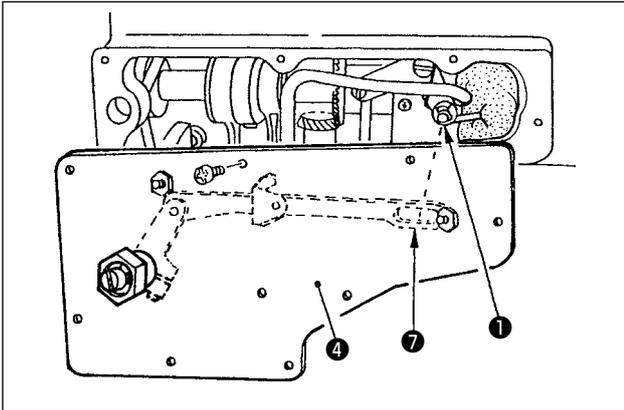
6. 把窗板（组件）**4**安装到缝纫机上。此时，电磁环**7**的长孔应正好安装在膝动提升横杆销**1**上。
