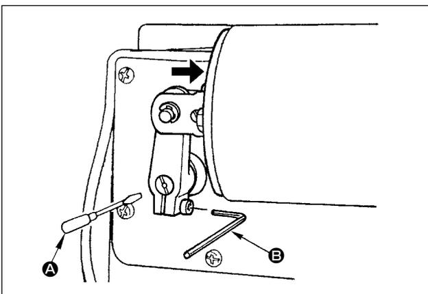
8. 下降压脚，与针板紧密接触。向箭头的方向推按电磁阀的状态下，用螺丝刀**A**向左转动电磁阀轴，然后用六角形杆扳手**B**拧紧套筒螺丝。
