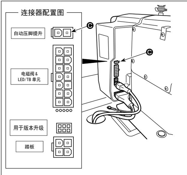
10. 把电磁阀的连接器连接到电气箱背面的 AK 电磁阀用连接器 C 上。
