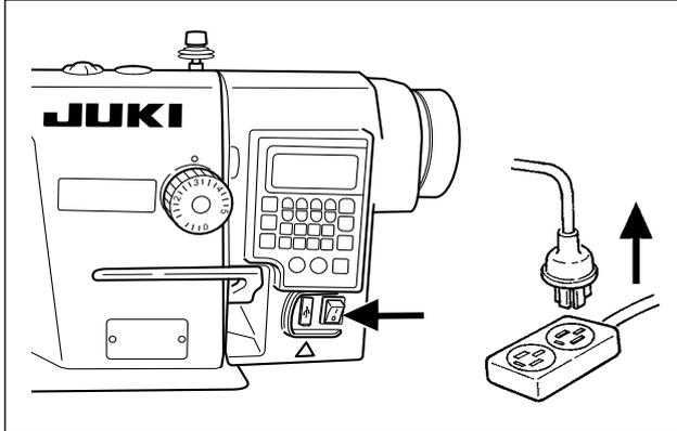
1. 确认了缝纫机确实停止之后，请关闭（OFF）电源开关，切断电源。
