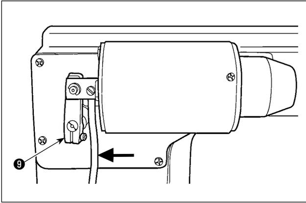
9. 把电磁阀的电线穿到电磁阀轴⑨内侧。
