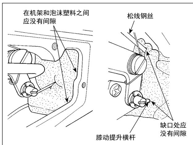
4. 如图所示那样确认泡沫塑料是否放入。与图不符时，请穿上侧缺口部的松线钢丝，下侧缺口部穿膝动提升横杆，不能有间隙。另外，还请确认机架和泡沫塑料之间是否没有间隙。
