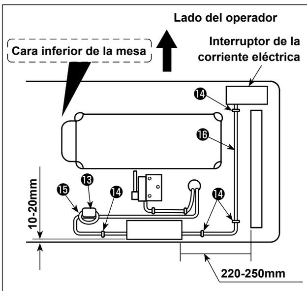
10) Instale el sujetacable anular ⑬ accesorios. Para el sujetacable anular ⑬ sujete el cable eléctrico de la caja eléctrica después de enrollar el cable dos vueltas alrededor del toro del sujetacable anular.
