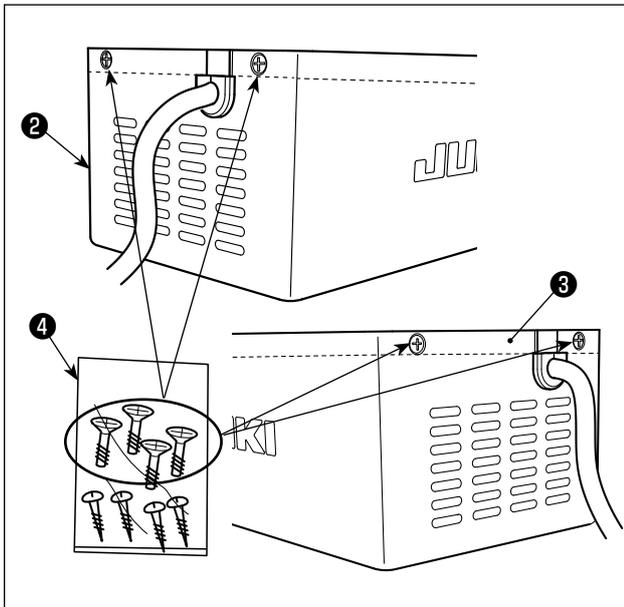
9) Saque los tornillos de fijación de la cubierta del reactor ⑤ de la bolsa de tornillos ④ . Fije la cubierta del reactor ② al conjunto de la base del reactor ③ con los tornillos de fijación (en cuatro ubicaciones).
