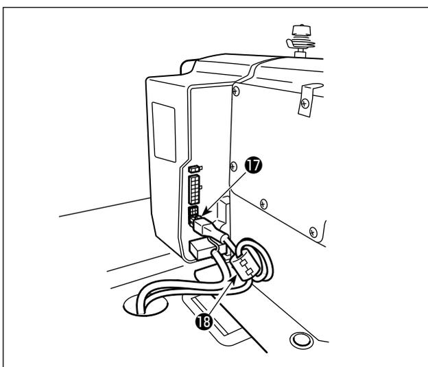
12) Instale el sujetacables anular ⑱ accesorios. Para un sujetacables anular ⑱ , sujete el cable ⑰ del sensor del pedal después de enrollar el cable tres vueltas alrededor del toro del sujetacables anular.
