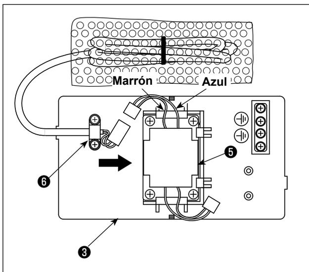
2) Deslice el reactor ⑤ en la dirección de la flecha para insertar en el conjunto de la base del reactor ③ .
