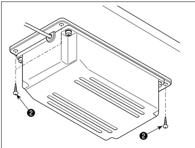
2) Retire los tornillos para madera ❷ de la bolsa de accesorios e instale la caja del reactor debajo de la mesa.
