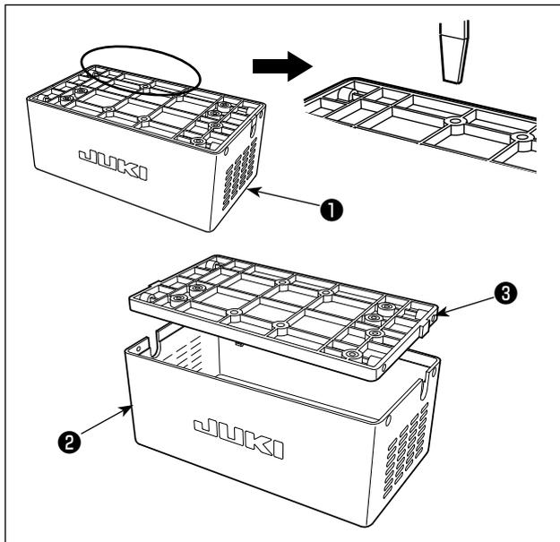
1. Extraiga la cubierta del reactor ② de la caja del reactor ① para separarla del conjunto de la base del reactor ③ .
