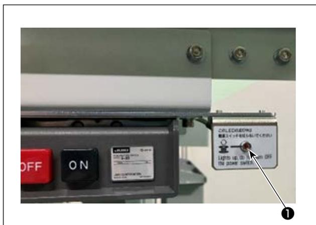
Le témoin ❶ monté à côté de l'interrupteur d'alimentation indique que le dispositif fonctionne.
