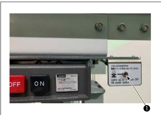
Die neben dem Netzschalter montierte Lampe ❶ zeigt an, dass die Vorrichtung in Betrieb ist.
