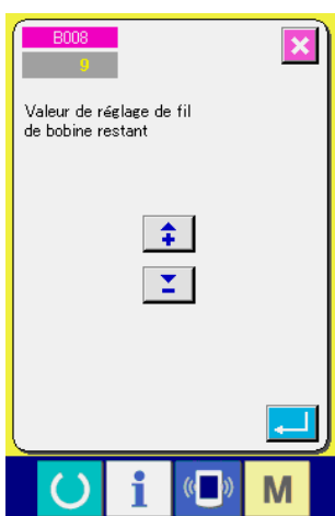
Ecran de réglage de la quantité restante de fil de canette (Ecran B)
