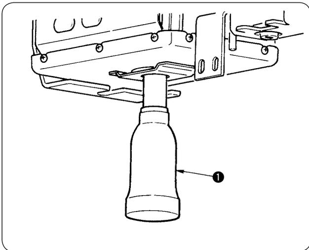
Den Ölsammelbehälter zum Entfernen drehen, und das Altöl ablassen, wenn der Ölsammelbehälter ① an der Maschinenbettabdeckung etwa halb voll ist.
