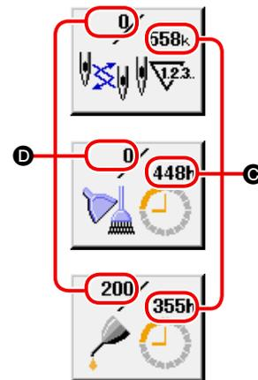
Die Intervalle **C** zur Meldung der Inspektions- und Restzeit **D** bis zum Wechsel werden auf den jeweiligen Postentasten **B** angezeigt.
