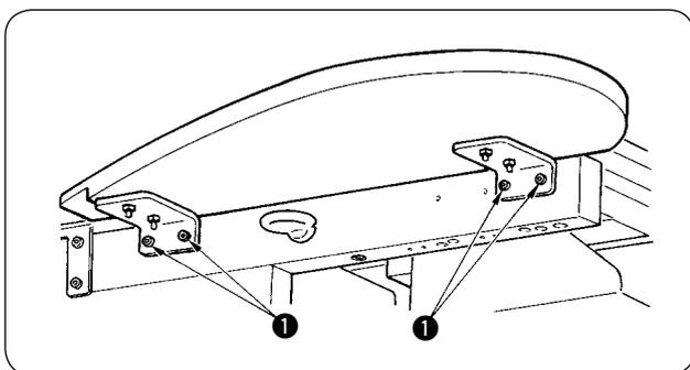
Installieren Sie den Zusatztisch mit vier Schrauben ①, wie in der Abbildung gezeigt.
