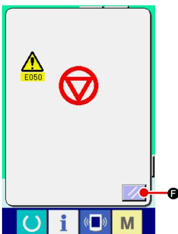
In diesem Fall wird der Fehlermeldebildschirm angezeigt, um auf das Drücken der Stoptaste aufmerksam zu machen. Durch Drücken der Rücksteltaste **F** wird der Fehler aufgehoben und das Display auf den Eingabebildschirm zurückgeschaltet.
