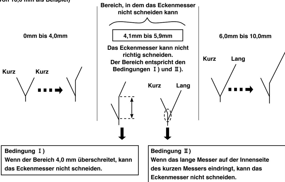
(Vorsicht) Wenn die Nähart geändert wird, müssen die Positionen des Eckenmessers und Mittenmessers anhand von Probenähen unbedingt überprüft werden, bevor die Maschine benutzt wird.
