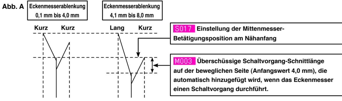
Die Betätigungsposition des Mittenmessers ändert sich je nach dem langen und kurzen Eckenmesser wie folgt. Wenn ein Wechsel von der Kombination aus zwei kurzen Eckenmessern zur Kombination aus langem und kurzem Eckenmesser durchgeführt wird, verschiebt sich die Schnittposition des Mittenmessers, falls das Mittenmesser an derselben Position bleibt. (Abb. B) Daher muss die Schnittposition des Mittenmessers geändert werden.
