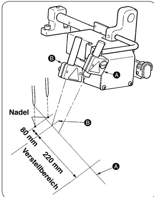
Die Markierungsleuchte auf der Vorderseite, vom Bediener aus gesehen, wird für die Einstellung der Referenzlinie **A** (feststehend) in Längsrichtung verwendet, während die Leuchte auf der Rückseite für die Einstellung der Referenzlinie **B** in Querrichtung (je nach Nähtyp verstellbar) verwendet wird.
