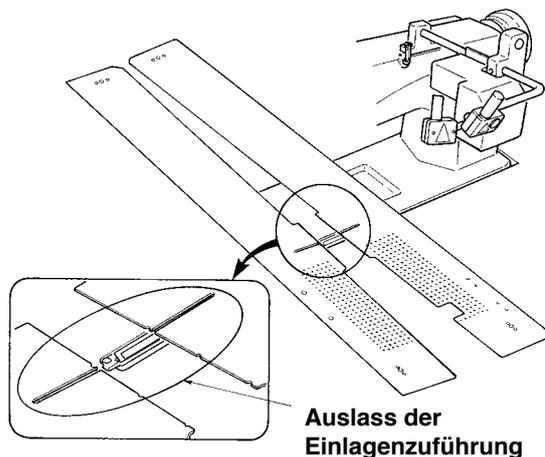
2. Wenn die Nähtischplatten bei den folgenden Typen entfernt werden, muss darauf geachtet werden, dass die Taschenbeutel- und die Einlagen-Klemmvorrichtungen nicht verbogen werden.
