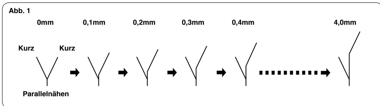
Wenn die Ablenkung des Messers 4,0 mm überschreitet, wie in Abb. 2 gezeigt, schneidet das Messer auf der Außenseite nicht.
