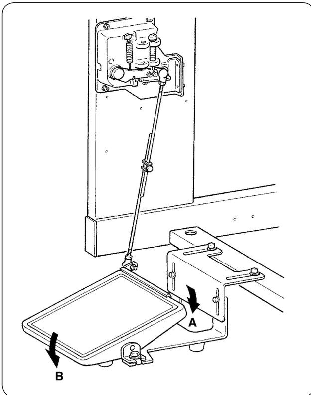
Das Pedal besitzt 7 Stufen in Richtung A und eine Stufe in Richtung B.
