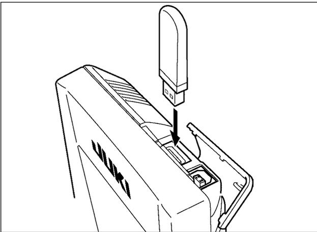
Schieben Sie die obere Abdeckung auf, und stecken Sie das USB-Gerät in den USB-Anschluss. Kopieren Sie anschließend die zu verwendenden Daten vom USB-Gerät auf das Hauptgerät. Nachdem die Daten kopiert wurden, entfernen Sie das USB-Gerät.
