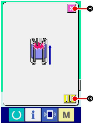
⑤ **Drücken Sie das Pedal bei der Montage der Brusttaschenvorrichtung nach hinten.**
