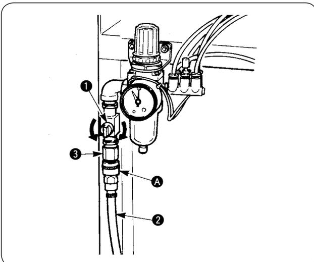
Schließen Sie das eine Ende der im Lieferumfang der Maschine enthaltenen Luftschauchkupplung A an den Luftschauch ② an. Schließen Sie dann das andere Ende an die Kupplung ③ auf der Maschinenseite an.
