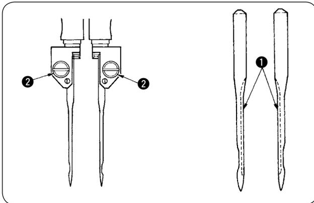
Die verwendeten Nadeln sind DP x 17 #14 bis #18 (Standard #16). Verwenden Sie die vorgeschriebenen Nadeln.
