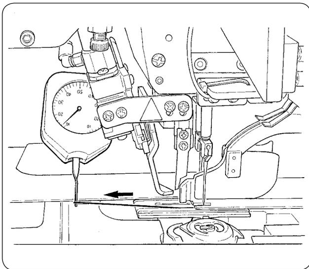
Wie in der linken Abbildung gezeigt, beträgt die normale Spulenfadenspannung 0,25 bis 0,35 N, wenn mit einem Spannungsmesser gemessen wird.
