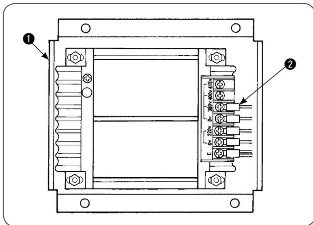
Wird der optionale Hochspannungstransformator ① mit einer Eingangsspannung von 400 V oder 415 V verwendet, muss das Eingangsstromquellenkabel ② des optionalen Hochspannungstransformators ① ausgewechselt werden. Das an 380 V angeschlossene Stromquellen-Eingangskabel ② (himmelblau) an die Klemme von 400 V oder 415 V anklennen.
