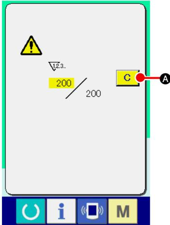
Wenn während der Näharbeit der Aufwärtzählzustand erreicht wird, wird der Aufwärtzählbildschirm angezeigt und der Summer ausgelöst. Drücken Sie die Löschtaste **C** **A**, um den Zähler zurückzustellen, worauf der Nähbetriebsbildschirm wieder auf dem Display erscheint. Der Zählvorgang beginnt nun wieder von vorn.
