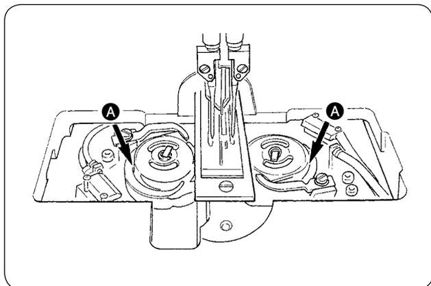
Füllen Sie den Öltank vor der Inbetriebnahme der Nähmaschine mit Öl für die Greiferschmierung.
