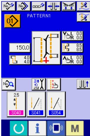
Wenn das Eckenmesser einen Schaltvorgang durchführt, wird der Parameter der überschüssigen Schaltvorgang-Schnittlänge ( **S017** / **S018** ) zusätzlich zu dem Parameter ( **M002** / **M003** ) der Mittenmesser-Betätigungspositionseinstellung automatisch hinzugefügt.
