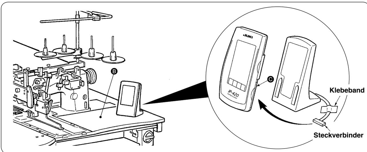
Öffnen Sie den Deckel auf der rechten Seite ③ der Tafel IP-420, und schließen Sie den mit Klebeband an der rechten Oberseite ② des Tisches gesicherten Steckverbinder an.
