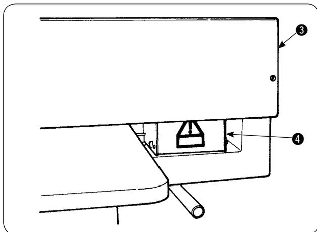
Der optionale Hochspannungstransformator ① wird auf der Rückseite des Tisches angebracht. Zur Durchführung der Spannungsumschaltung den Transformatorkasten ④ nach Abnehmen der Deckplatte ③ entfernen.
