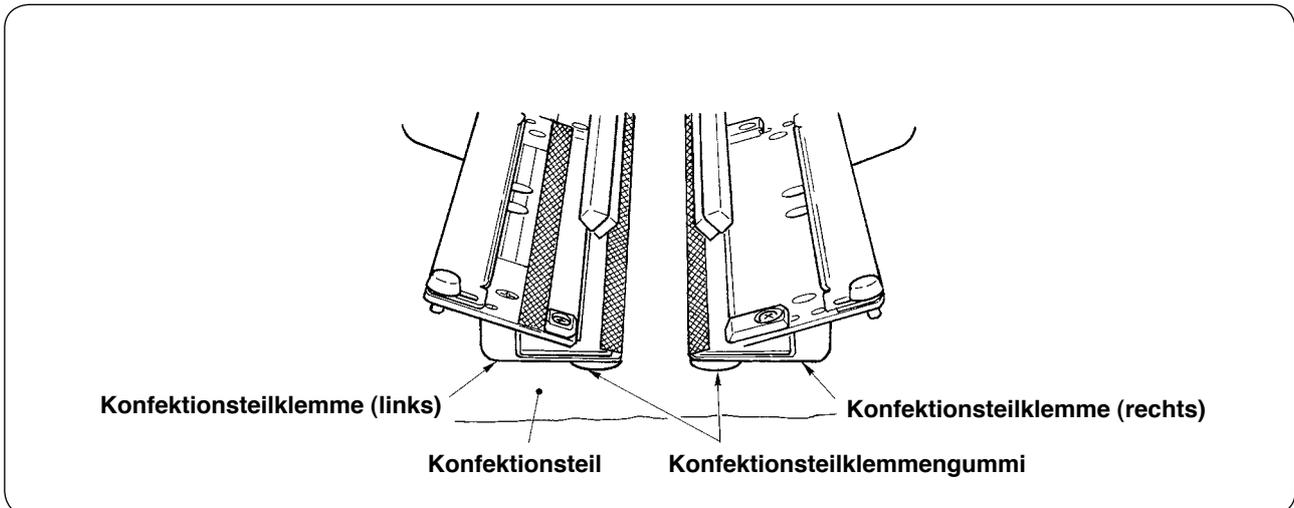
Verwenden Sie ein Konfektionsteil, das größer als das unter die rechte und linke Konfektionsteilklemme geklebte Gummikissen ist.
