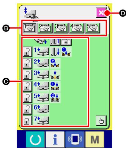
② Wählen Sie unter den Tasten **B** eine der 5 registrierten benutzerdefinierten Pedaloperationen aus. Dabei wird der Inhalt der ausgewählten Pedaloperationsdaten bei **C** angezeigt.
