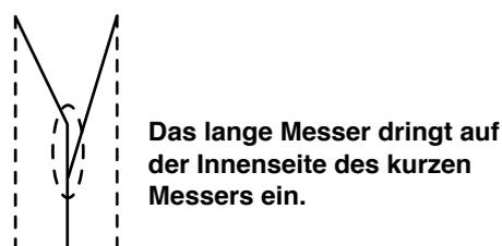
Im Falle einer der oben beschriebenen Bedingungen schneidet das Eckenmesser nicht, und die Fehlermeldung (E480/E481) von „Einstellung, bei der das Eckenmesser nicht schneidet“ wird auf der Tafel angezeigt.
