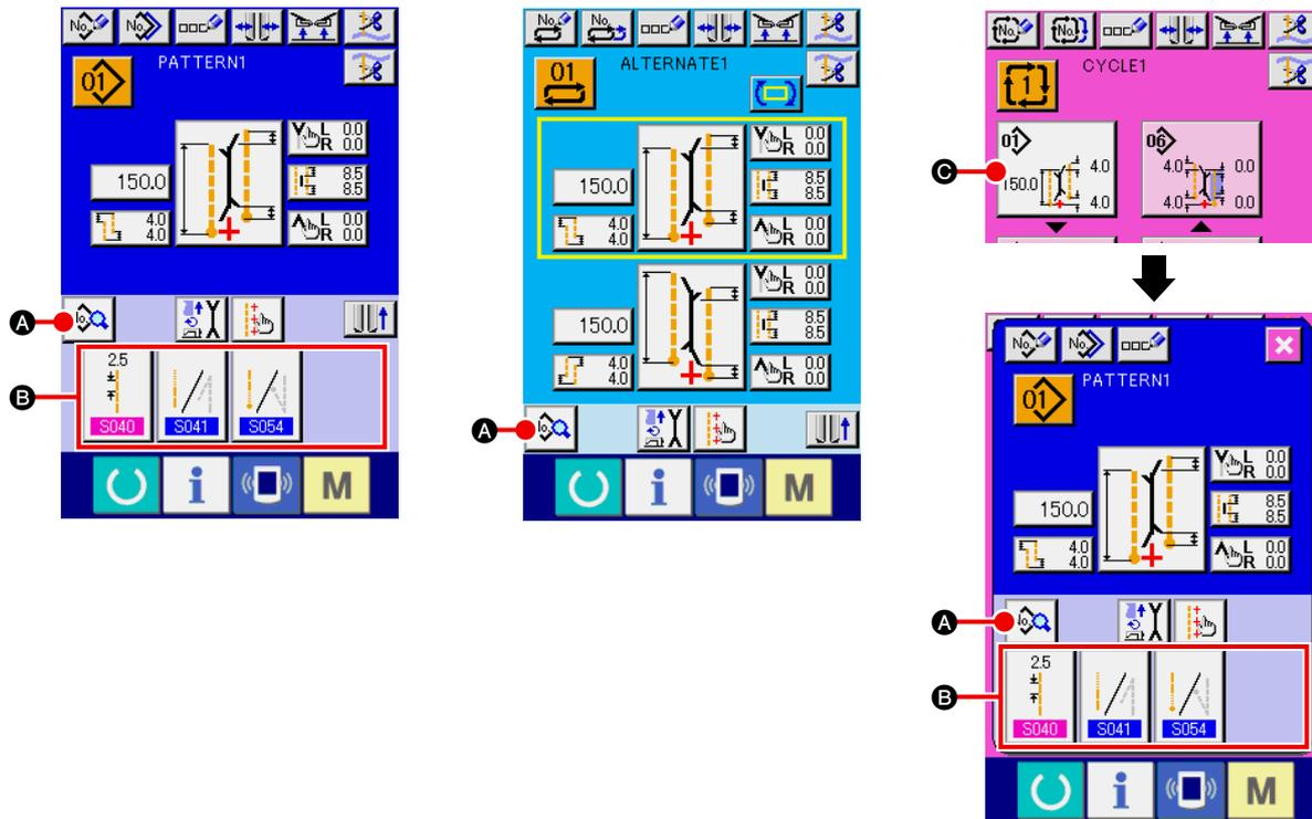
1. Wenn Sie die Nähdaten des Zyklusnähmodus ändern wollen, drücken sie die Musterdaten-Bearbeitungstaste **C**, um eine Änderung zu ermöglichen.
