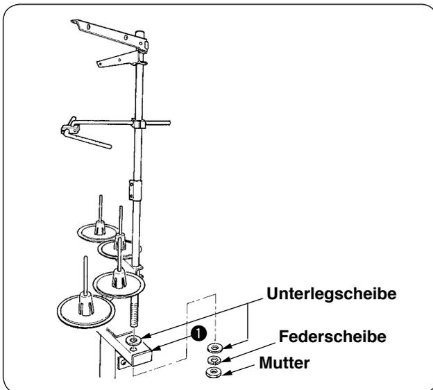
Befestigen Sie den Garnständer mit einer Mutter und Unterlegscheiben am Maschinenrahmen **1**, wie in der linken Abbildung gezeigt.
