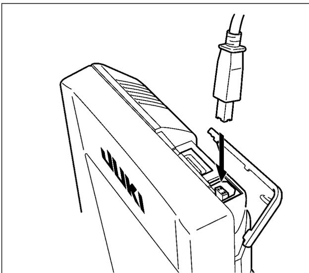
Daten können über ein USB-Kabel zu/von einem PC oder dergleichen gesendet/empfangen werden.
