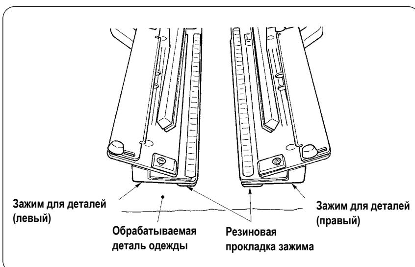
Обрабатываемая деталь одежды должна соответствовать по размеру зажимам для удерживания обрабатываемого материала расположенным справа и слева. При обработке деталей меньшего размера резиновые прокладки зажимов могут соскочить, что приведет к сбоям в работе машины. При необходимости обработки детали меньшего размера, используйте зажимы с дополнительной прокладкой.
