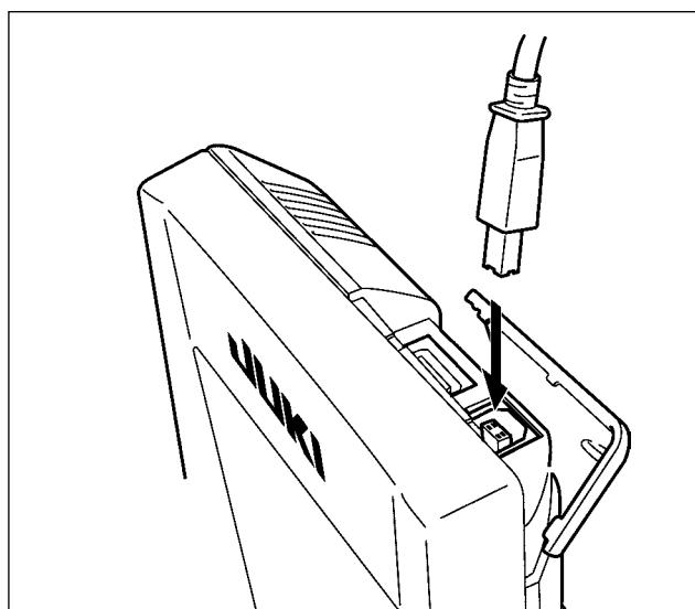
Данные могут отправляться/получаться на/с персонального компьютера и т.п. при помощи кабеля USB.
