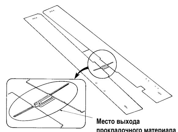
2. В случае снятия столешниц ① и ②, такого типа как описано ниже, будьте осторожны и не погните зажим накладного кармана и зажим прокладочного материала.
