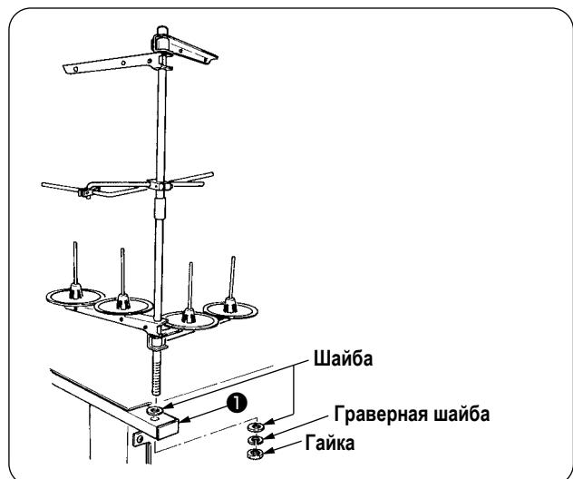
Установите гайку и шайбу между рамой ① и стойкой, и зафиксируйте стойку для нити как показано на рисунке слева.
