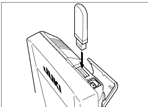
Откройте верхнюю крышку и вставьте устройство USB в порт USB . После чего, скопируйте данные использования с устройства USB в основной корпус.
