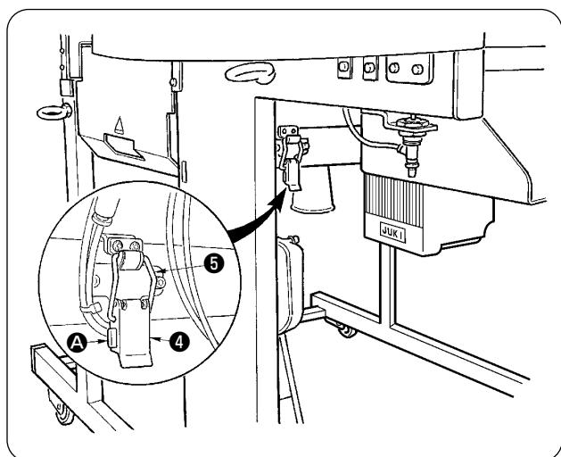
③ Освободите зафиксированный шарнир машины. Нажмите на секцию А, освободите зафиксированный шарнир машины ④ , и снимите крючок петли ⑤ .
