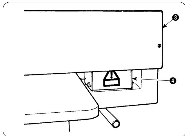
Трансформатор высокого напряжения ① установлен с задней стороны стола. При выполнении работ по изменению напряжения, снимите блок трансформатора ④ с машины, предварительно сняв кожух ③ .
