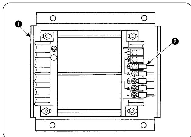
При использовании трансформатора высокого напряжения ① с входным напряжением 400В или 415В, необходимо изменить подключение силового кабеля ② к трансформатору ① . Подключите силовой кабель ② (голубого цвета), который был соединен с клеммой на 380В, к клемме на 400В или 415В.
