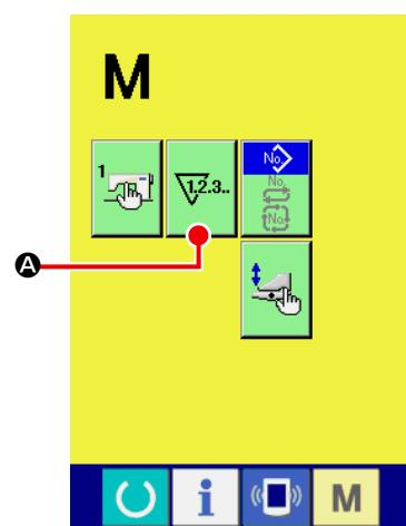
① Переход в режим отображения окна установки счетчика
