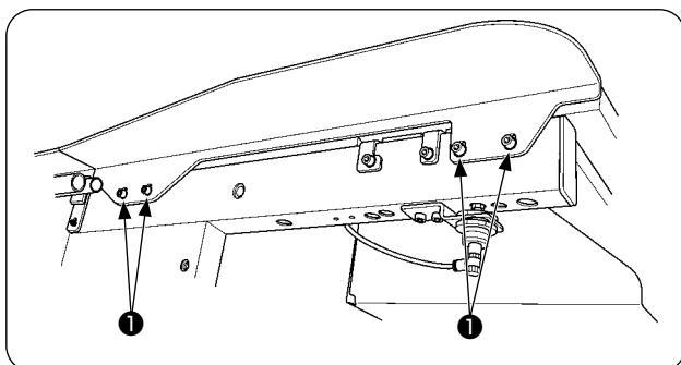
Установите накладной столик с помощью четырех винтов **1** как показано на рисунке.
