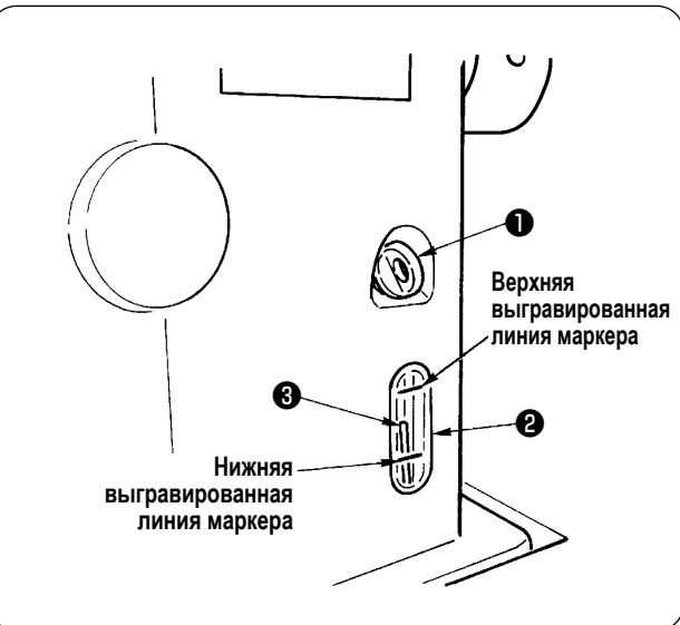
Заправьте масляный резервуар маслом для смазки челнока перед началом работы швейной машины.
