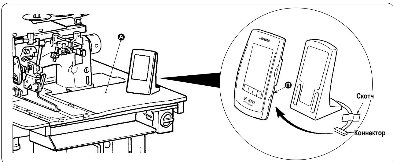
Как указано на рисунке выше, откройте крышку с правой стороны секции **B** панели IP-420 и подключите коннектор, одновременно закрепив кабель справа на верхней части стола **A** с помощью скотча.
