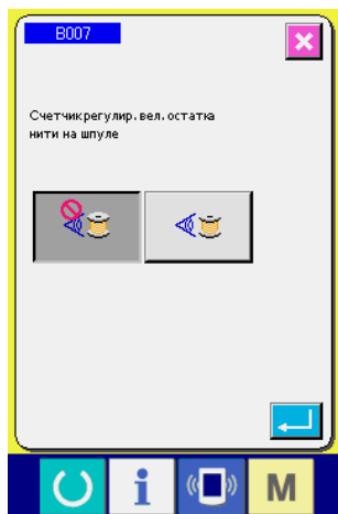
Окно установки счетчика остатка шпульной нити (Окно B)
