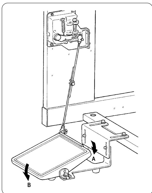
Педаль имеет 7 шагов регулировки в направлении **A** и один шаг в направлении **B**. Выполните регулировку панели в соответствующих шагах.
