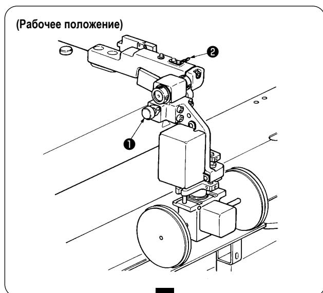
Когда роликовый укладчик не используются или необходимо отрегулировать угловой нож, роликовый укладчик может быть повернут вверх в соответствии с процедурой, описанной ниже.
