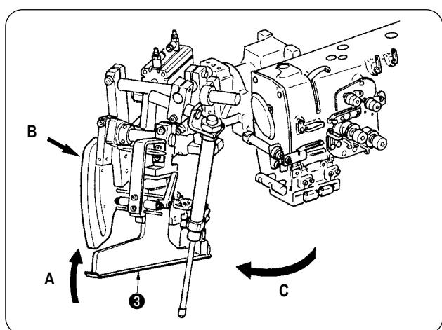
② Поверните рубильник для подгибания среза бейки. Поднимите рубильник ③ в направлении А, поддержите секцию В вручную и поверните рубильник в направлении С.
