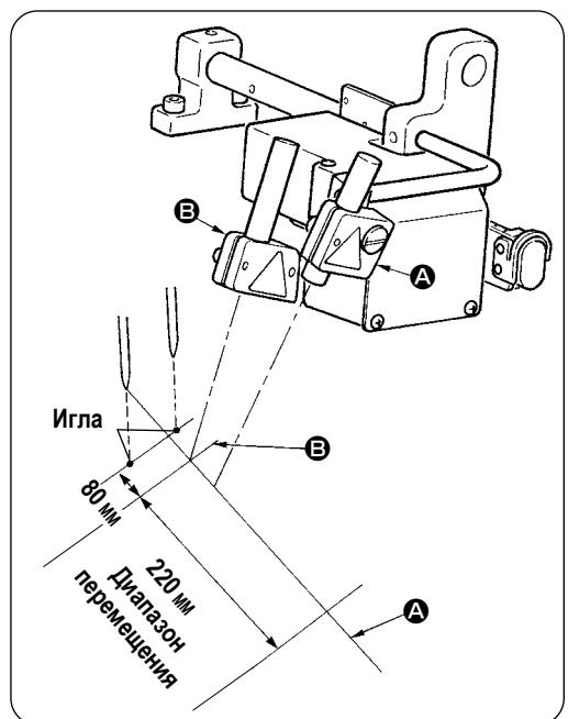
Луч светового маркера на передней стороне, наблюдаемой от стороны оператора, используется для (фиксированный) **A** установки метки продольной линии шитья, а с тыльной стороны – для поперечной установки метки линии шитья (перемещающейся в соответствии с типом шитья) **B**.
