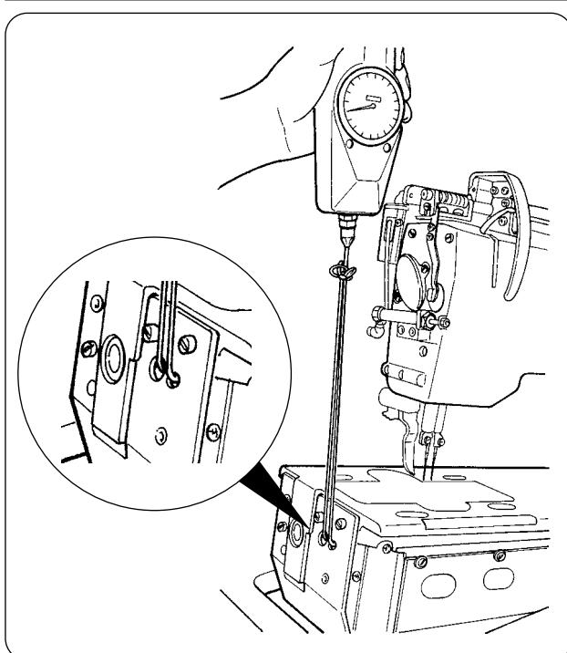
Пневматическая пружина - один из расходных материалов. Газ в пневматической пружине закончится естественным образом, даже когда частота ее использования низкая, и пружина не сможет оказать противодействие, чтобы обеспечить безопасность. В случае усилия 130Н или более при пропускании пружин через передний край станины машины и при подъеме машины, как показано на рисунке слева, необходимо быстро заменить пружину оригинальной пневматической пружиной JUKI (№ детали : 40023177).
