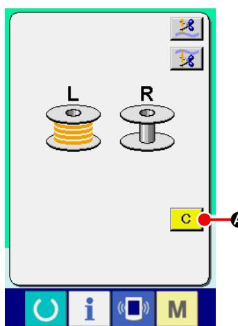
После того, как значение счетчика остаточной длины шпульной нити становится равно "0" в конце выполнения строчки, на экране появляется окно счетчика по возрастанию и звучит звуковой сигнал. Необходимо заменить шпульку, на которой заканчивается нить.
