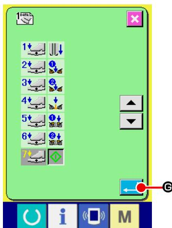
При достижении установки последней функции на экране отображается кнопка ВВОДА G, после нажатия на которую происходит сохранение введенных данных.
