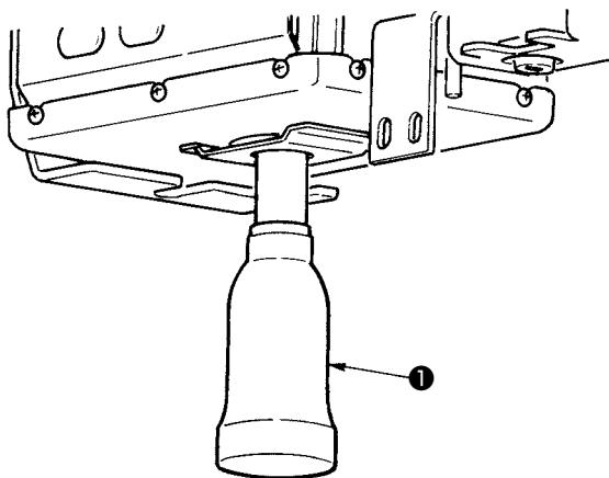
Открутите и снимите резервуар и слейте отработанное масло при заполнении его наполовину. Резервуар для отработанного масла ① расположен в нижней части поддона машины.
