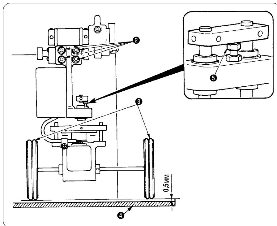
① Установка параллельности
