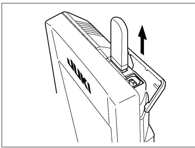
Выньте устройство USB . Установите крышку на место.
