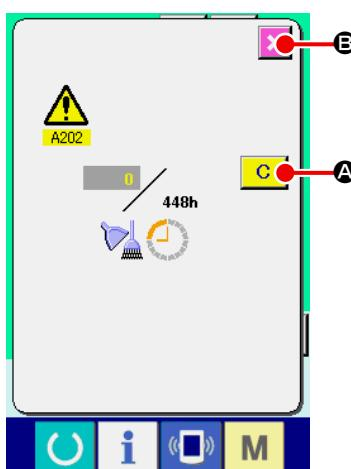
При достижении предустановленного времени обслуживания на экране отображается предупреждение. В случае необходимости обнуления времени обслуживания, нажмите кнопку ОЧИСТКА A. Время обслуживания очищено и всплывающее окно B закрыто. В противном случае нажмите кнопку ОТМЕНА B и закройте всплывающее окно. Каждый раз при завершении одного процесса шитья на экране будет отображаться предупреждение, пока время обслуживания не будет очищено.
