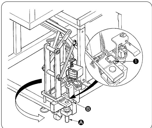
Прижимная плата укладчика находится в положении, при котором она фиксирует укладчик в сложенном положении на раме во время осуществления транспортировки машины.
