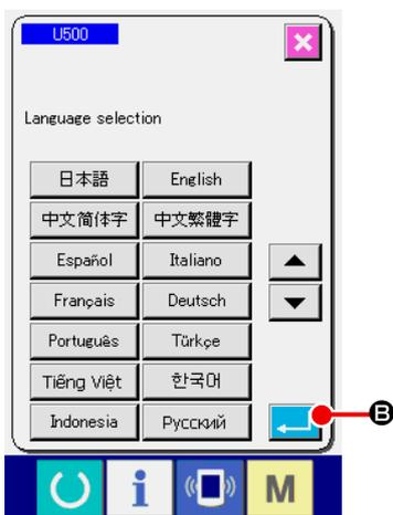
A continuación, se visualiza la pantalla emergente de selección de idioma. Después de seleccionar el idioma que desee visualizar, pulse el botón ENTER **B**. Luego, se visualiza la pantalla de entrada de cosido independiente (pantalla A) que se muestra en la figura de abajo.
