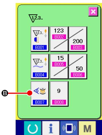
② **Impostare il contatore di regolazione della quantità rimanente di filo della bobina su ON (abilitato).**
