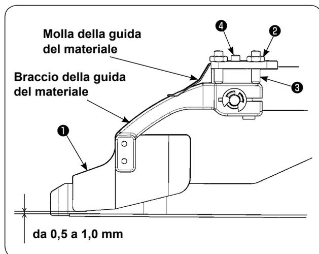
① L'altezza della guida del materiale può essere regolata allentando il dado **2** e la vite **3**. (Spazio fra la guida del materiale e il regolo del filetto è stato regolato ad un valore da 0,5 a 1,0 mm al momento della consegna.)
