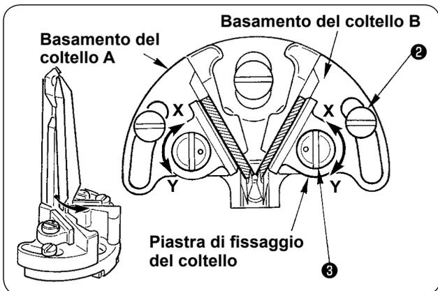
L'angolo di inclinazione del coltello dell'angolo di questo modello è stato regolato in fabbrica a 60°
