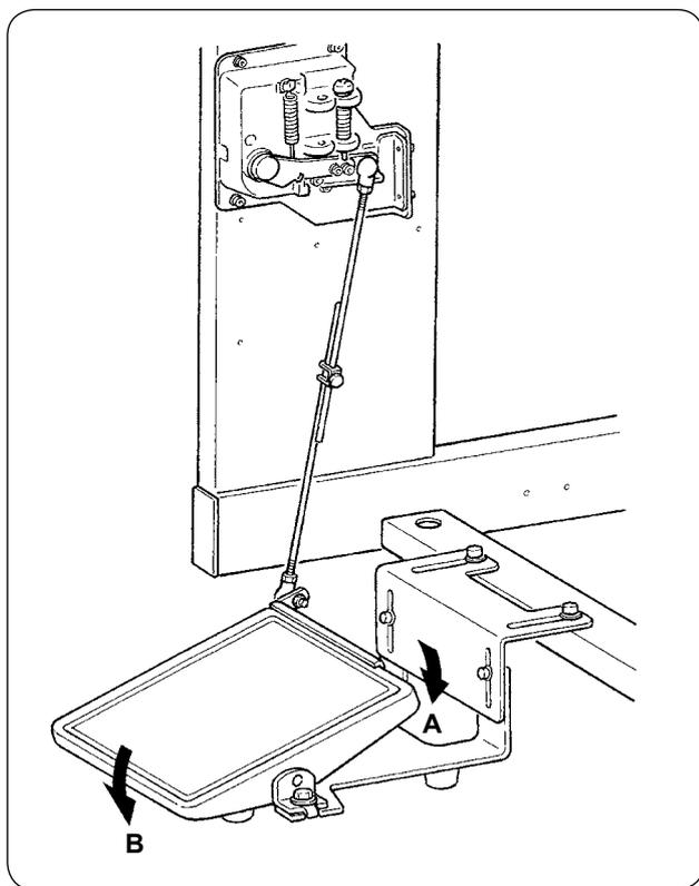
Il pedale ha n.7 posizioni nel senso **A** e n.1 posizione nel senso **B**.
