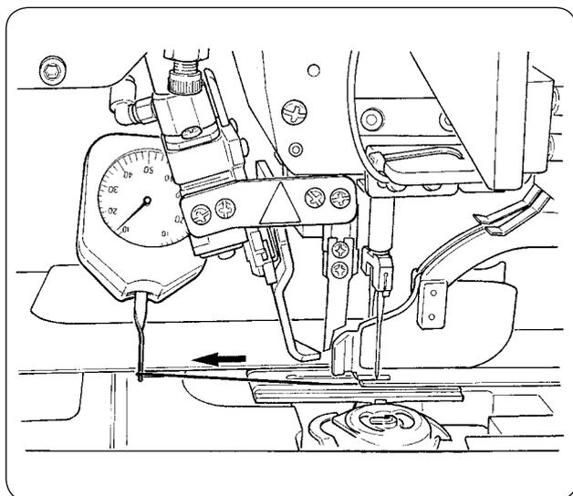
Come mostrato nella figura a sinistra, la tensione standard del filo della bobina è da 0,25 a 0,35N quando si misura con il misuratore di tensione.
