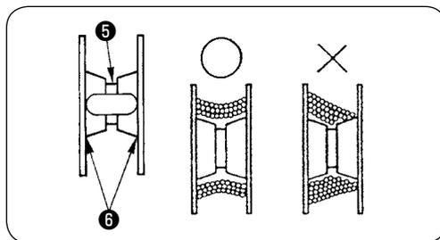
1. Quando si avvolge la bobina, iniziare ad avvolgerla dalla cavità ⑤ come illustrato nella figura qui sopra. Se si inizia ad avvolgere la bobina dalla sezione ⑥, è possibile che il rilevamento dell'esaurimento del filo della bobina non venga effettuato in modo regolare.
