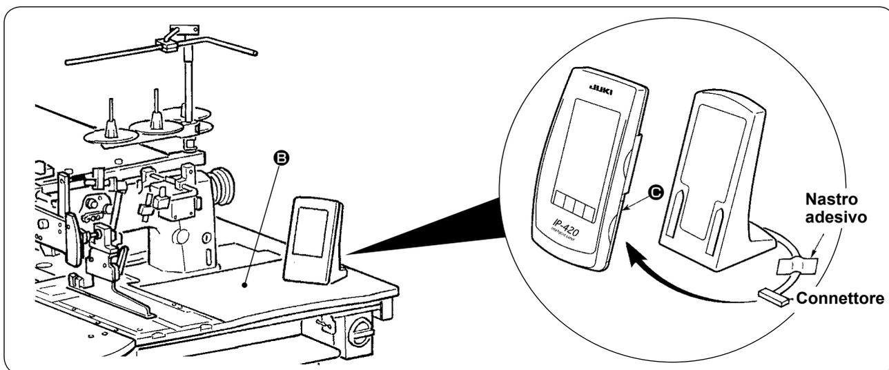
Come mostrato nella figura indicata qui sopra, aprire il coperchio sulla sezione ③ del lato destro del IP-420 e collegare il connettore fissato con nastro adesivo alla superficie superiore destra ⑤ del tavolo.
