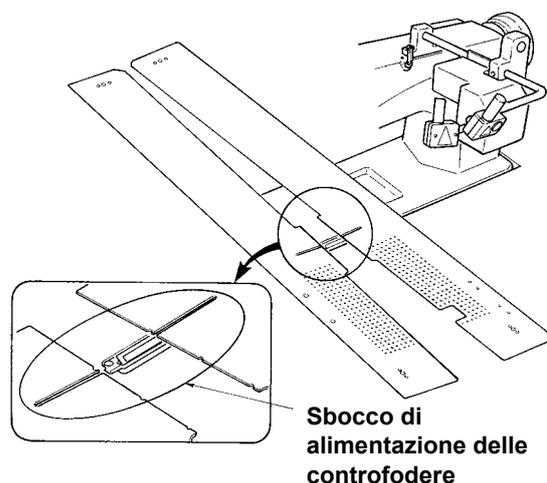
2. In caso di rimuovere i piani di cucitura con i tipi indicati qui sotto, fare attenzione a non piegare il dispositivo di tenuta del taschino e il dispositivo di tenuta della controfodera.
