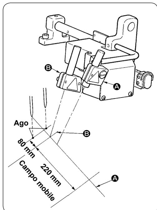
La luce della lampada di marcatura sul lato anteriore, vista dalla parte dell'operatore, è usata per l'impostazione del riferimento per la linea longitudinale (fissa) **A** e quella sul lato posteriore è usata per l'impostazione del riferimento per la linea laterale (mobile secondo il tipo di cucitura) **B**.
