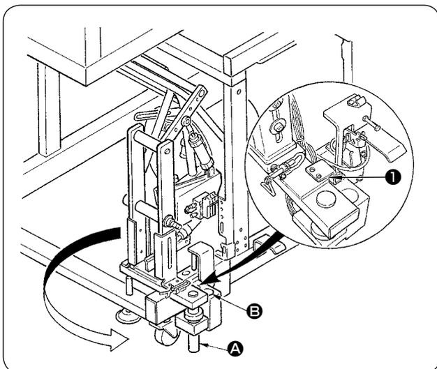
L'impilatore a barre viene consegnato nello stato in cui l'impilatore è fissato nel telaio al momento della consegna con l'impilatore montato. Quindi è necessario cambiare la posizione di montaggio alla normale posizione di utilizzo.
