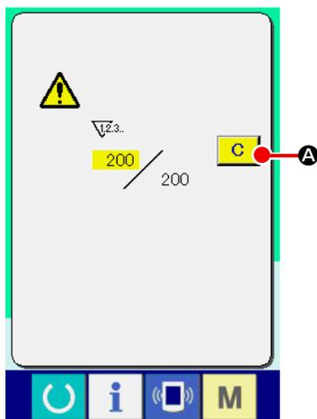
Quando lo stato di conteggio completato viene raggiunto durante il lavoro di cucitura, lo schermo di conteggio completato viene visualizzato e il cicalino squittisce. Premere il bottone CLEAR **C** **A** per ripristinare il contatore, e lo schermo ritorna allo schermo di cucitura. Il contatore quindi comincia a contare nuovamente.
