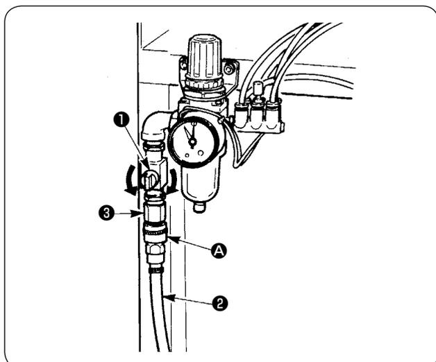
Collegare un'estremità dell'accoppiatore dell'aria A in dotazione con la macchina come un accessorio al tubo dell'aria 2 . Collegare quindi l'altra estremità all'accoppiatore 3 sul lato unità principale.
