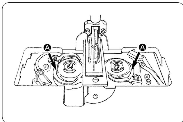
Riempire il serbatoio dell'olio con l'olio per la lubrificazione del crochet prima di mettere in funzione la macchina per cucire.
