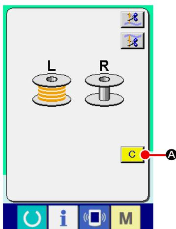
Quando il valore del contatore di quantità rimanente di filo della bobina diventa "0", la cucitura finisce, lo schermo di conteggio completato viene visualizzato e il cicalino squittisce. Sostituire il filo della bobina, della bobina nella quale il filo della bobina rimane poco.
