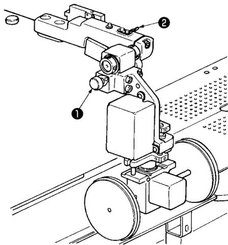
Quando l'impilatore a rulli non è utilizzato, o quando si regola il coltello dell'angolo, l'impilatore a rulli può essere girato verso l'alto con la procedura sottostante.
