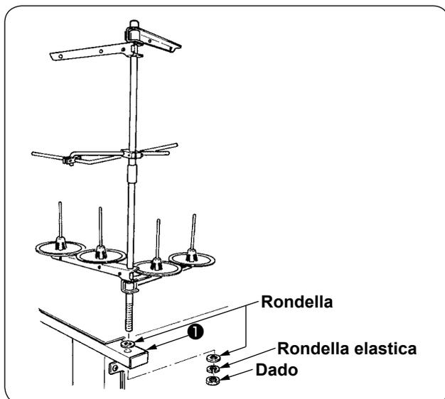
Mettendo il dado e le rondelle sopra e sotto il telaio dell'unità principale ❶, fissare il portafilo come mostrato nella figura a sinistra.
