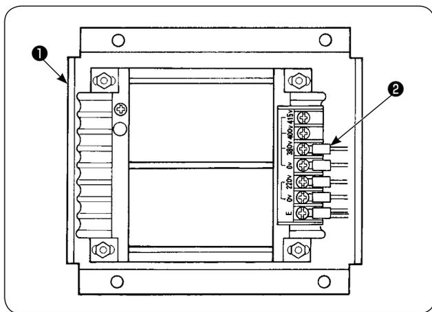
Quando si usa il trasformatore optional ad alta tensione ① con la tensione d'ingresso di 400V o 415V, è necessario cambiare il collegamento del filo di alimentazione d'ingresso ② del trasformatore optional ad alta tensione ①. Cambiare il filo di alimentazione d'ingresso ② (azzurro) collegato a 380V al collegamento di 400V o 415V.
