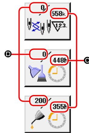
L'intervallo **C** per informare dell'ispezione e il tempo rimanente **D** fino alla sostituzione vengono visualizzati nei rispettivi bottoni di articolo **B**.
