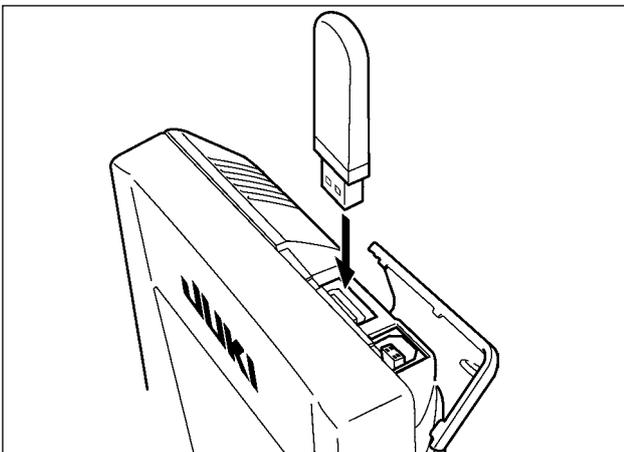
Fare scorrere il coperchio superiore ed inserire il dispositivo USB nella porta USB. Quindi, copiare i dati da usare dal dispositivo USB sul corpo principale. Dopo il completamento della copiatura dei dati, rimuovere il dispositivo USB.
