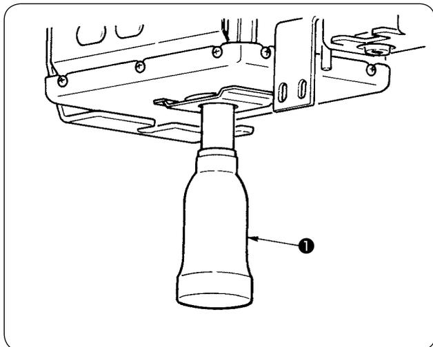
Girare e rimuovere il contenitore dell'olio, e scaricare l'olio di scarico quando l'olio di scarico si è accumulato fino alla metà circa del contenitore dell'olio **1** posto sul coperchio del basamento della macchina.
