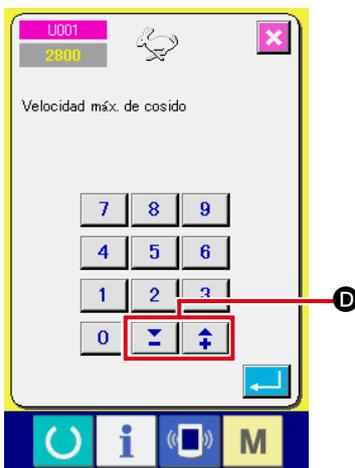
El No. de color rosado tal como el **U001** se introduce en los ítems de dato para cambiar numerales y el valor fijado se puede cambiar con los botones + / -
