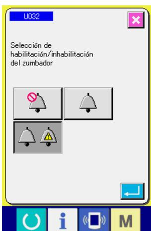
El No. en color azul tal como el **U032** se pone en los ítems de datos para seleccionar pictógrafos y los pictógrafos visualizados se pueden seleccionar en la pantalla de cambios.
