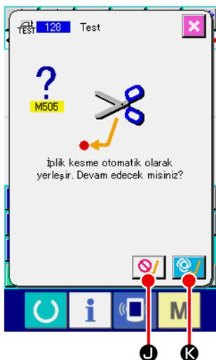
Nel caso che il comando di taglio del filo non esista nella coda del modello di cucitura e prima del trasporto a salto, lo schermo di conferma dell'inserimento del taglio del filo automatico viene visualizzato dopo aver premuto il bottone SEWING PREPARATION e inserimento del taglio del filo K o non inserimento J può essere selezionato.
