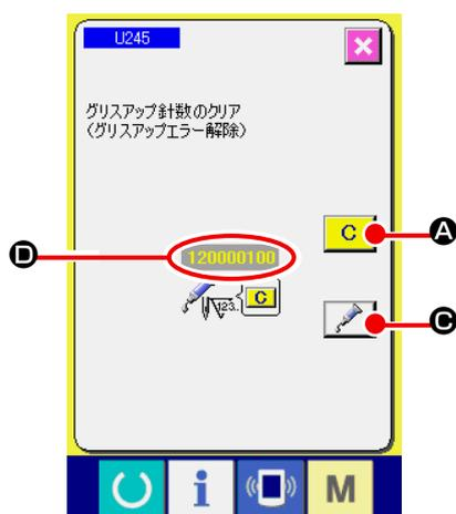
一定の針数を縫製すると、電源投入時にエラー「E220 グリスアップ警告」が表示されます。これは、指定箇所のグリス補充時期を知らせるもので、必ず下記のグリス補充を行ってください。その後、メモリースイッチ U245 を呼び出してクリアボタン **C** **A** を押し、針数 **D** を“0”にしてください。
