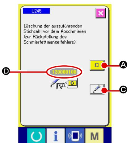
Wird die Rückstelltaste **B** gedrückt, ohne die angegebenen Stellen abzuschmieren, erscheint Fehlercode “E221 Schmierungswarnung” jedes Mal, wenn die Stromversorgung danach erneut eingeschaltet wird, und die Maschine funktioniert nicht. Lassen Sie daher Sorgfalt walten.
