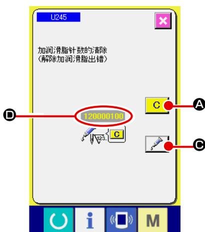
缝制了一定的针数之后, 打开电源时, 会显示出出错「E220 加润滑脂警告」。这是缝纫机自动通知现在到了需要向指定部位补充润滑脂的时期, 因此请一定补加下列的润滑脂。然后, 请呼出存储器开关 **U245**, 按清除按键 **C** **A**, 并把针数 **D** 设定为“0”。
