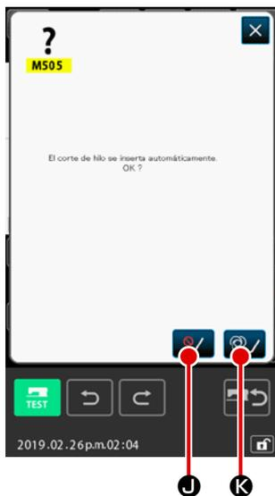
En el caso en que no exista comando de corte de hilo en la terminación de patrón antes del transporte de salto, la pantalla de confirmación de inserción de corte de hilo se visualiza después de presionar el botón
