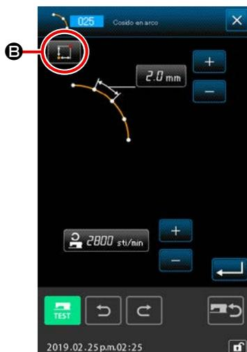
El cambio alternativo entre la inserción relativa y la inserción absoluta se puede efectuar en la pantalla de ajuste **B** de ítems de cosido.
