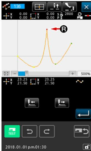
Cuando usted quiera mover el punto **R** a punto **S**, el resultado cambiará seleccionando ya sea el punto de configuración posterior **2** o frontal **3**.
