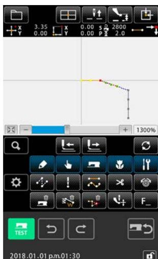
Los datos de patrón posteriores a los puntos eliminados no se desplazan pero los datos de patrón anteriores y posteriores a los puntos eliminados son unidos por el transporte de saltos.
