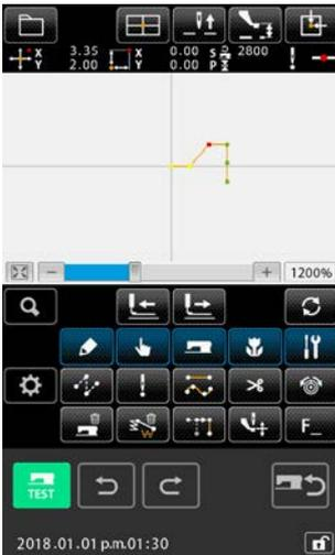
Im Falle einer Relativpunktverschiebung wird das ganze Muster nach dem verschobenen Punkt verschoben, während die vorherige Beziehung beibehalten wird.
