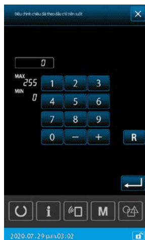
< Màn hình điều chỉnh chiều dài đầu mút chỉ trên suốt >
