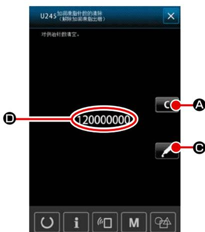
缝制了一定的针数之后，打开电源时，会显示出出错「E220 加润滑脂警告」。这是缝纫机自动通知现在到了需要向指定部位补充润滑脂的时期，因此请一定补加下列的润滑脂。然后，请呼出存储器开关 U245，按清除按钮
