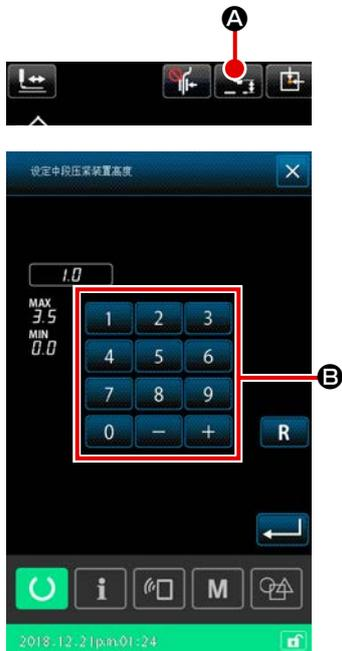
按下压脚高度设定按钮
