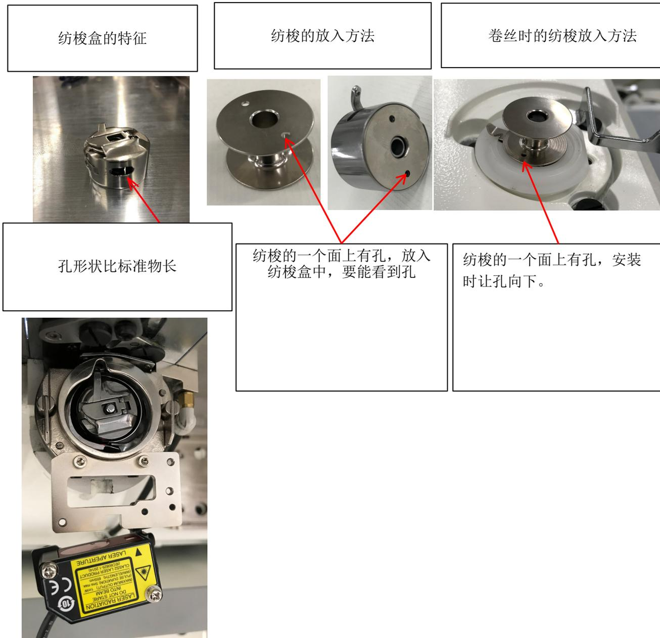
② K302:将下丝残量探知功能选择设定为“光学方式”。
