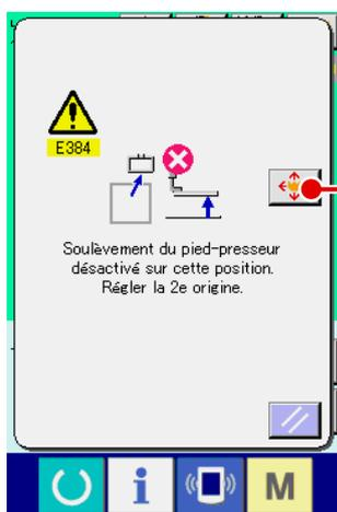
Si l'on essaie de lever le pied presseur dans la zone d'interdiction de levage du pied presseur, l'erreur E384 d'interdiction de levage du pied presseur apparaît.
