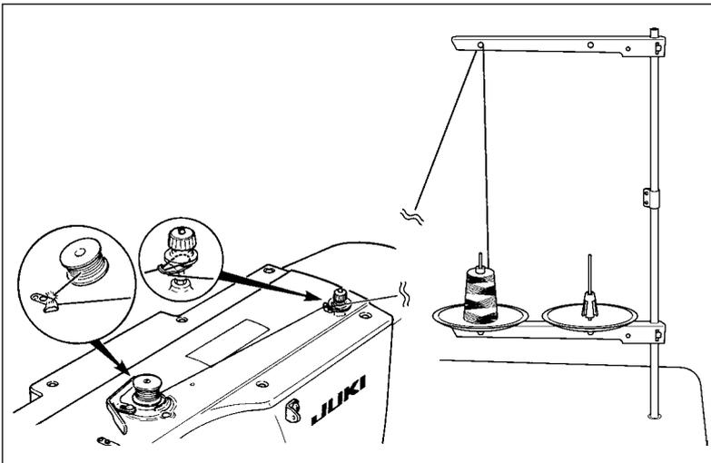
Enfiler le bobineur et enrouler le fil sur la canette dans le sens indiqué sur la figure.
