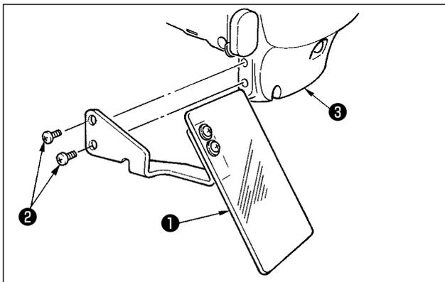
Utiliser le couvercle de protection des yeux **1** après l'avoir fermement fixé sur le couvercle de la plaque avant **3** avec les vis **2**.
