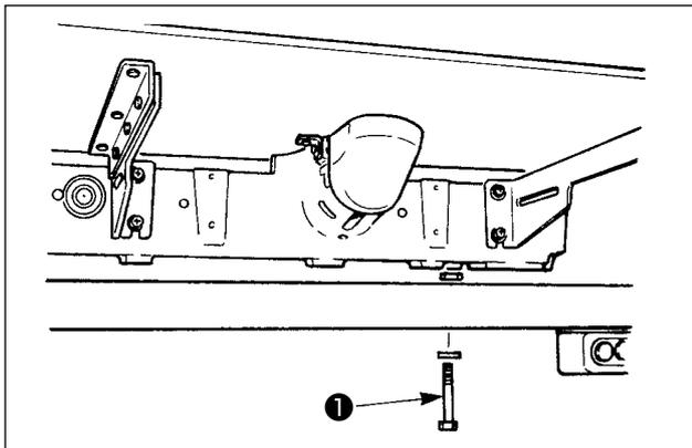
Retirer le boulon de fixation du socle ❶
