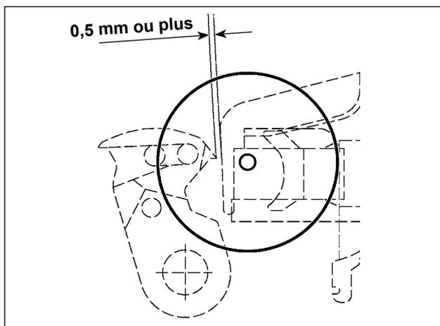
Après le retour au point d'origine, appuyer sur la touche **REGLAGE PRET** du panneau IP pour vérifier si un dégagement de 0,5 mm ou plus est ménagé entre l'extrémité supérieure du couteau et l'extrémité supérieure du pince-fil d'aiguille. S'il n'est pas possible de ménager un dégagement de 0,5 mm ou plus, régler la position du couteau mobile sur  $18,5 \pm 0,5$  mm pour assurer le dégagement spécifié.
