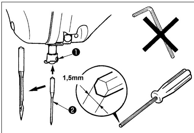
Dévisser la vis de fixation ❶ et tenir l'aiguille ❷ avec sa gorge longue tournée vers vous. Introduire l'aiguille bien à fond dans le trou de la barre à aiguille et revisser la vis de fixation ❶.
