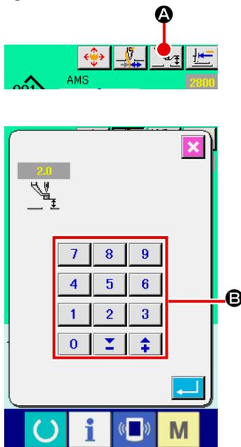
Appuyer sur le bouton PARAMETRAGE DU PRESSEUR INTERMEDIAIRE **A**, puis à l'aide du pavé numérique **B**, régler le jeu entre la face inférieure du presseur intermédiaire et le tissu à 0,5 mm (grosesseur du fil utilisé).
