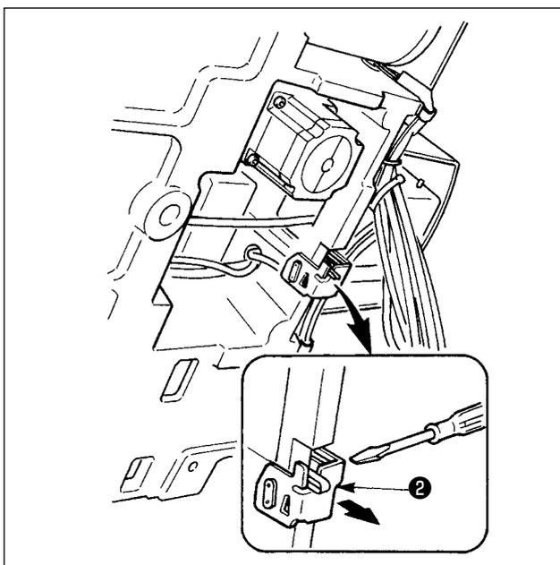
Si l'erreur 302 se produit pendant le fonctionnement de la machine après l'installation, desserrer la vis de fixation du contacteur de sécurité à l'aide d'un tournevis et déplacer le contacteur ❷ vers le bas de la machine.
