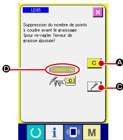
Lorsque la machine a été utilisée pendant un certain nombre de points, l'erreur "E220 Avertissement de graissage" s'affiche. Cet affichage indique à l'opérateur qu'il est temps de remettre de la graisse aux points spécifiés. Remettre alors de la graisse ci-dessous aux points spécifiés. Faire ensuite apparaître le paramètre U245, appuyer sur le bouton EFFACER **C** **A** et spécifier "0" comme NOMBRE DE POINTS **D**.
