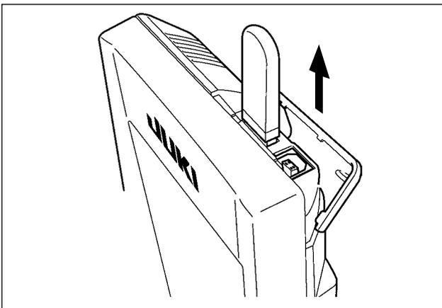
Retirer le dispositif USB. Remettre le couvercle en place.
