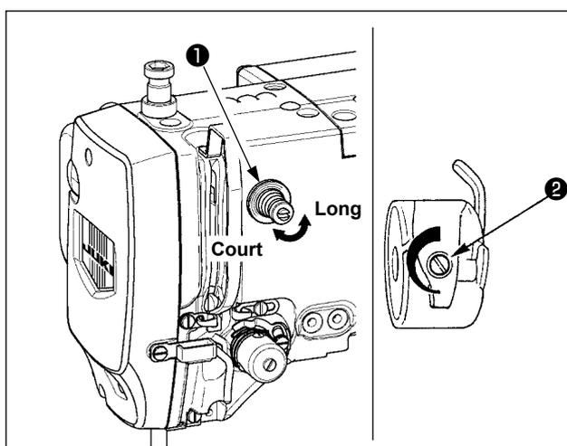
Pour raccourcir la longueur de fil restant sur l'aiguille après la coupe du fil, tourner le bloc-tension n° 1 ❶ dans le sens des aiguilles d'une montre. Pour la rallonger, tourner le bloc-tension dans le sens inverse des aiguilles d'une montre. Raccourcir la longueur autant que possible sans toutefois que le fil ne glisse hors du chas de l'aiguille. Régler la tension du fil d'aiguille sur le panneau de commande et la tension du fil de canette avec ❷.
