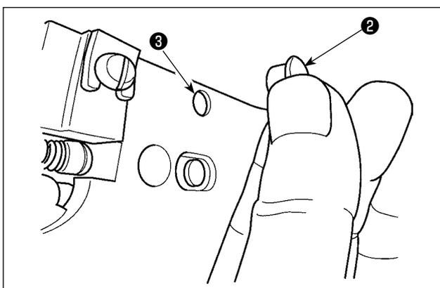
Si le fil se prend sur l'extrémité supérieure **1** du pince-fil d'aiguille, le fil est mal serré et il se produit des problèmes de couture au début de la couture. Retirer alors le fil avec des pincettes ou un instrument similaire.
