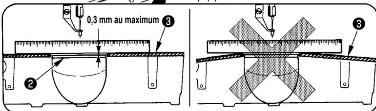
1. Fixer le couvercle auxiliaire de plaque à aiguille ③ de façon qu'il soit plus haut que la plaque à aiguille ② (0,3 mm au maximum). Lorsque le niveau est inférieur à la plaque à aiguille ②, une cassure de l'aiguille ou d'autres dérangements risquent de se produire à cause d'une mauvaise alimentation.
