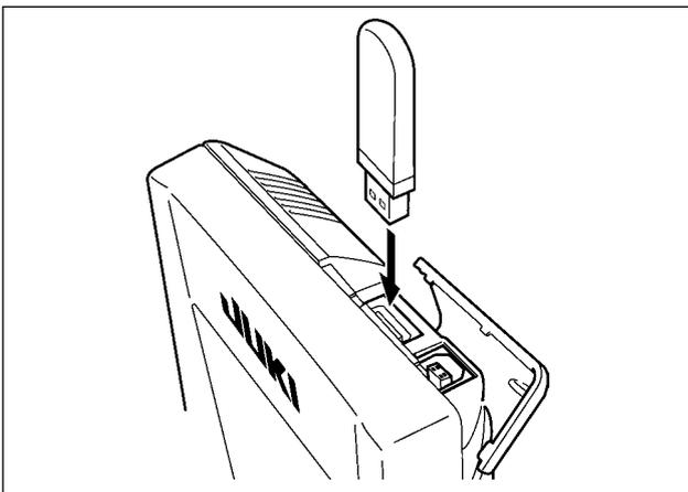
Faire glisser le couvercle supérieur et insérer le dispositif USB dans le port USB. Puis copier les données à utiliser du dispositif USB dans le corps principal.
