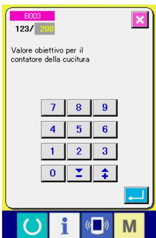
A questo punto, immettere il valore di impostazione. Quando "0" è immesso nel valore di impostazione, la visualizzazione dello schermo di conteggio ad addizione non viene effettuata.
