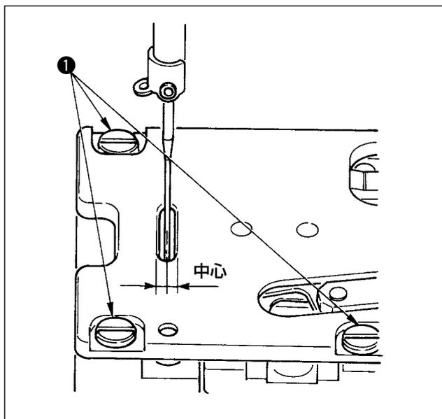
針穴の中心に針が入るようにねじ ① をゆるめて針板を調整します。
