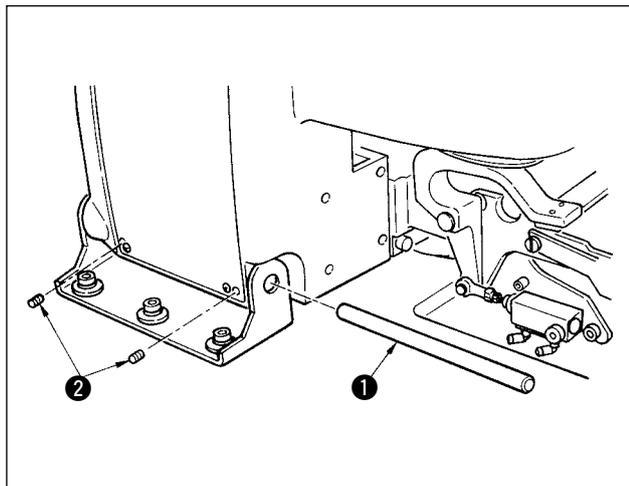
ミシンとアームステーの穴を合わせて、軸①を入れます。軸①の端面が両側に出ている状態で、ねじ②にて軸①を固定します。
