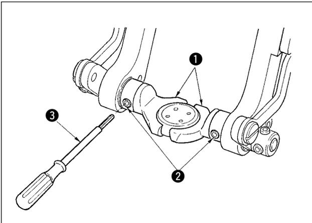
チャック ① を交換する場合には、付属の専用ドライバー ③ でねじ ② をゆるめて交換します。
