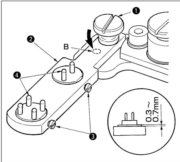
ボタンセットピン②を交換する場合には、つまみ①をゆるめて交換します。ただし、下記のセットピンに交換する場合には、つまみ①を外してB側のねじ穴に取り付け直してください。
