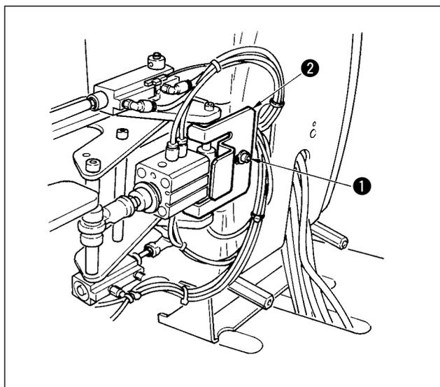
固定ねじ ① を取り外し、搬送用固定板 ② を取り外してください。
