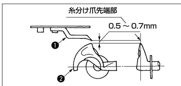
糸分け爪 ① とルーパ ② のすき間は 0.5 ~ 0.7mm になるように糸分け爪 ① をドライバーなどで曲げて調節します。
