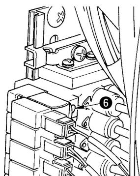
作業が終わったら、電磁弁のロック ⑥ の解除を忘れずに行ってください。
