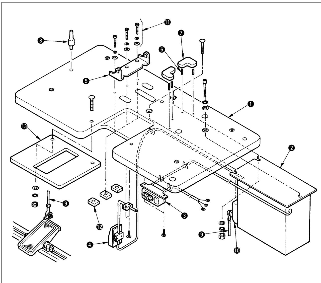
1) テーブル ① に、制御ボックス ②、電源スイッチ ③、補助テーブル ⑬、起動スイッチ ④ を取り付けます。
