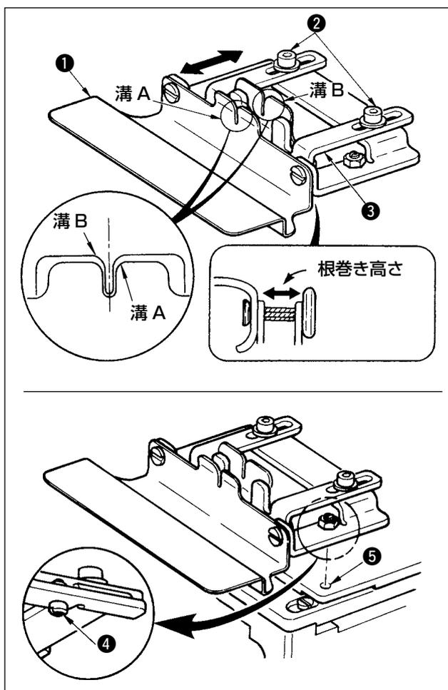
力(カウンタ)ボタン根巻き工程を行う場合は、根巻きアタッチメント(付属品)①を使用します。根巻きアタッチメントの高さ調整は、ねじ②をゆるめてホルダープレート③を前後させて行います。
