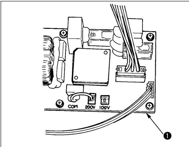
下記の2点の変更により、単相 100 V ~ 120V/単相/三相 200 V ~ 240V の切換えができます。
