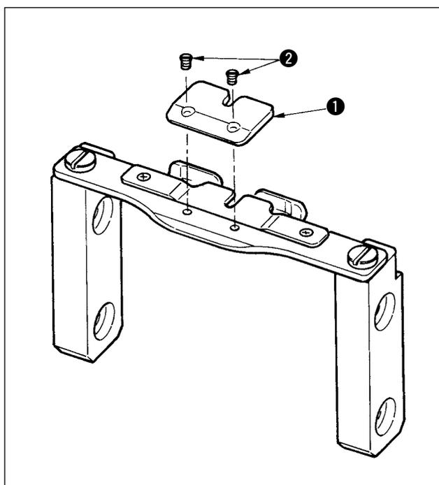
すくいベタ縫いを行う場合は、付属のアンダープレートスペーサA(品番:40020764)①をピン位置ではめ込んでください。また、常時使用する場合はねじ②で固定してください。アンダープレートスペーサは、布厚さによって、以下のものを選択して使用してください。
