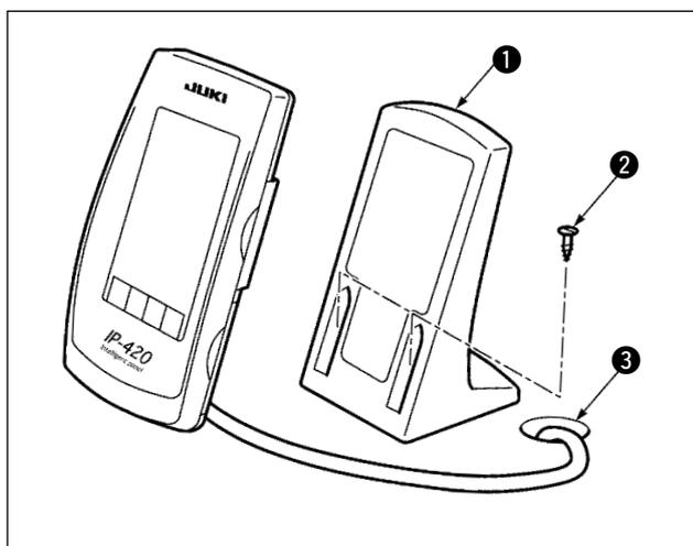
テーブル上に操作パネル取付板 ① を木ねじ ② で固定し、ケーブルをテーブル穴 ③ に通します。
