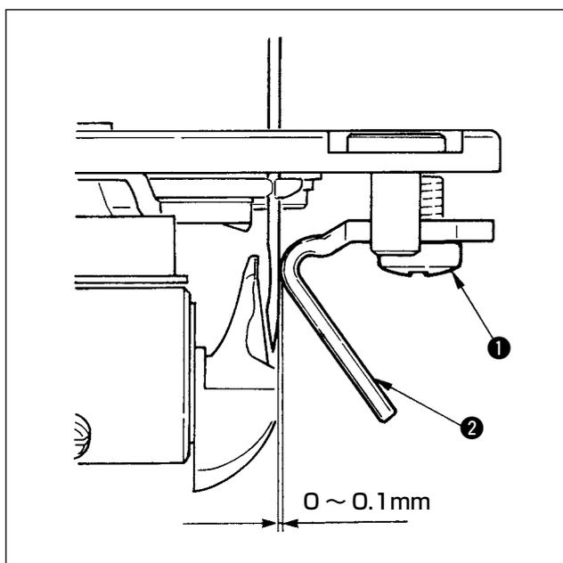
針棒最下点でねじ ① をゆるめ、針ガイド ② と針のすき間が 0 ~ 0.1mm になるように調整します。
