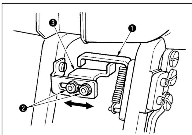
ボタン手差しモードに切り換えた場合は、フックA①を起立させ、開き量を少なくすることが出来ます。開き量は、ねじ②をゆるめ、フックB③を左右にスライドさせて調整してください。
