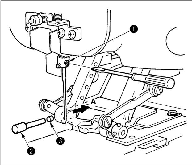
ミシン正面から見て、針のえぐり部が **A** 側にくるようにして、針棒の針穴の奥に突き当たるまでさし込み、マイナスドライバーで止めねじ **①** を締めてください。
