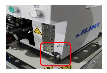
1.当需要打开控制机构和缝纫机头部分时,请旋转上图黑色旋钮至松开状态,然后向机器 逆时针方向拉动控制机构就可以打开了,工作时请务必锁紧此按钮。
