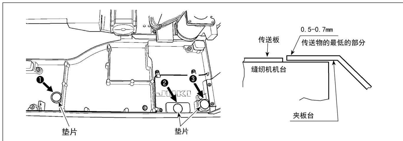
由于多年使用零件劣化造成机头变坏，缝合布料后布料的折边和缝迹宽（边缘）有可能发生偏移。
