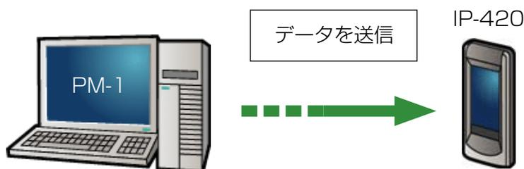
パソコンとIP-420を接続し、PM-1でデータ作成後ミシンへデータを送信してください。IP-420が、データ入力画面になると自動的に試縫い画面が表示されます。PM-1の操作方法については、PM-1のヘルプなどをご覧ください。
