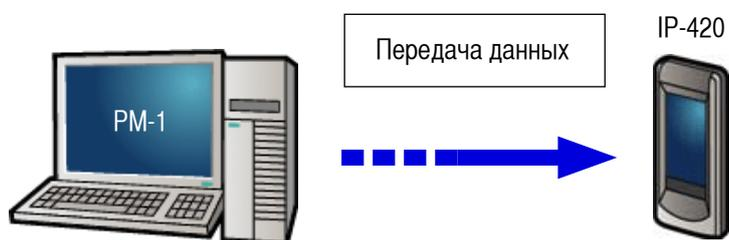
Подсоедините персональный компьютер с IP-420, создайте данные с помощью РМ-1. Затем отправьте данные на швейную машину. Когда IP-420 вызовет экран ввода данных, автоматически появится экран пробного шитья. Смотрите помощь для РМ-1, чтобы правильно управлять РМ-1.
