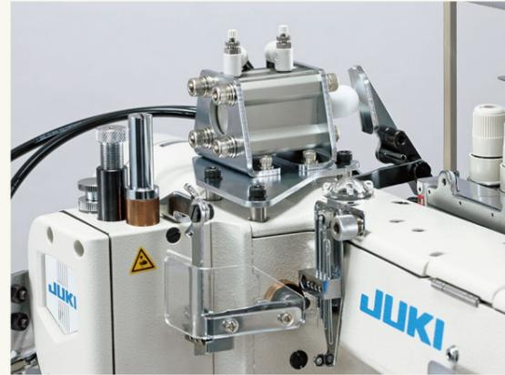
ペダルの踏み返しにより、押えの上げ下ろしができます。
