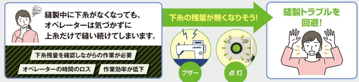
専用ピンを使用し、ピンの糸残量をセンサーで検知します。ピンの糸残量が規定値に到達するとブザーと緑ランプを点灯させ、ミシンを停止させることが出来ます。縫製オペレーターは下糸の残量を気にすることなく作業に専念でき、生産性が上がります。
